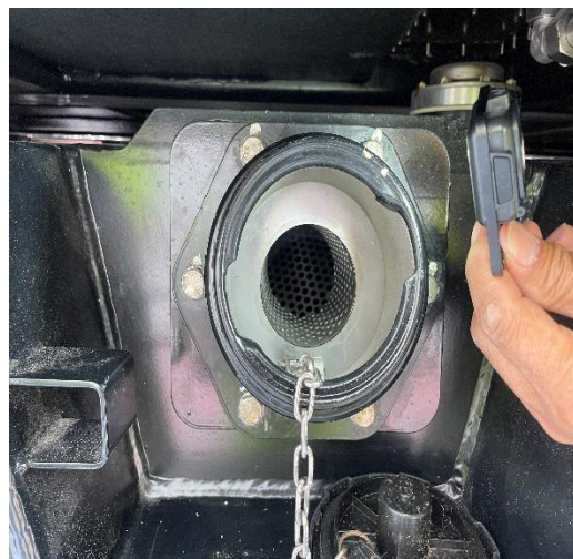
圖 2-6-3 R228 左右側注油孔網格方向裝 反(已改善)
