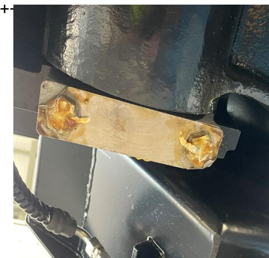
圖 2-16-6 R230 左下第三軸鐵片與螺栓未固定(已改善)
