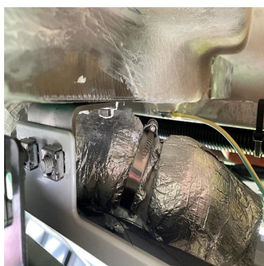
圖 2-6-6 R229 左側加油孔內側網格方向相反(已改善)
