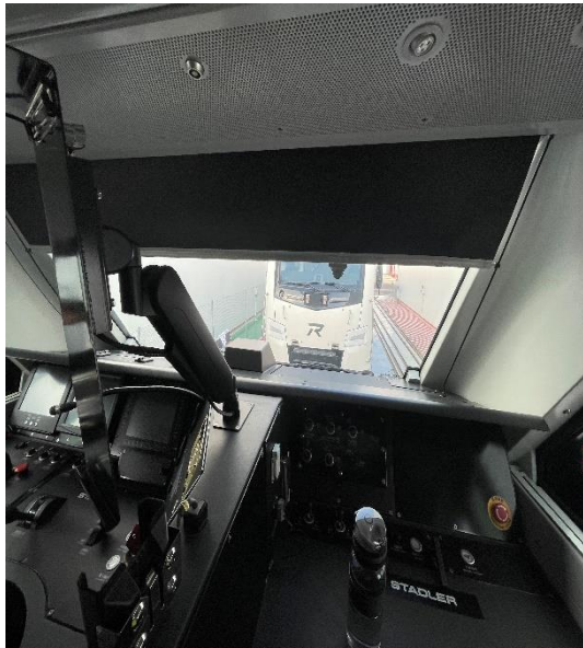
圖 2-6-1 R228 前端遮陽簾無法固定 (已改善)
