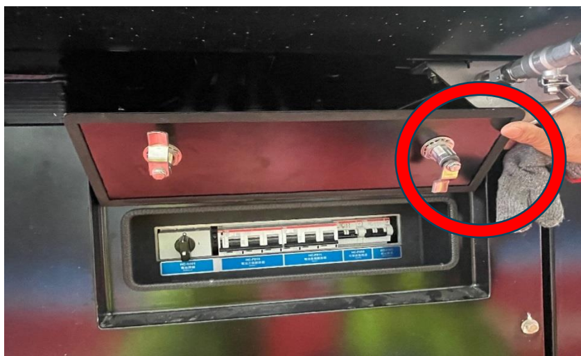
圖 2-9-2 R230 左側引擎啟動馬達機櫃右邊鎖頭鬆脫無法上鎖
