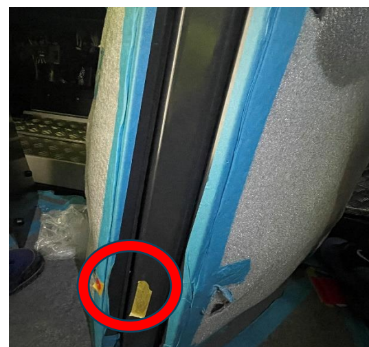
圖 2-18-4 R230 後端司機側下方蓋板干 涉不易鎖固
