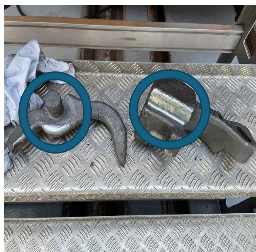
圖 2-4-6 R228 連結器研磨調整
