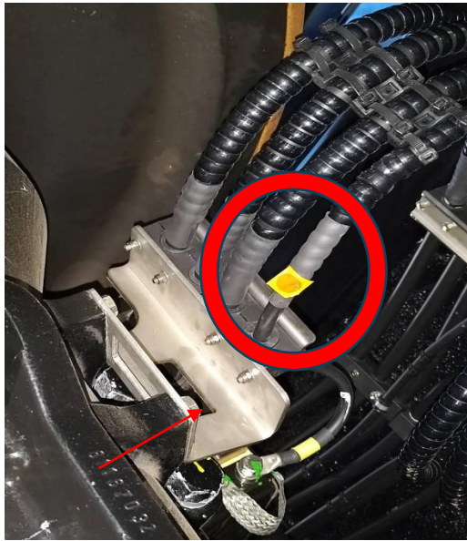
圖 2-13-1 R230 車下馬達引線保護套鬆脫
