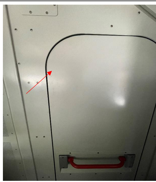
圖 2-18-2 R230 後端駕駛側後方門干涉 不易開啟(已改善)
