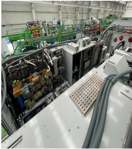
圖 2-17-1 R231 第三站全車電器線路測試
