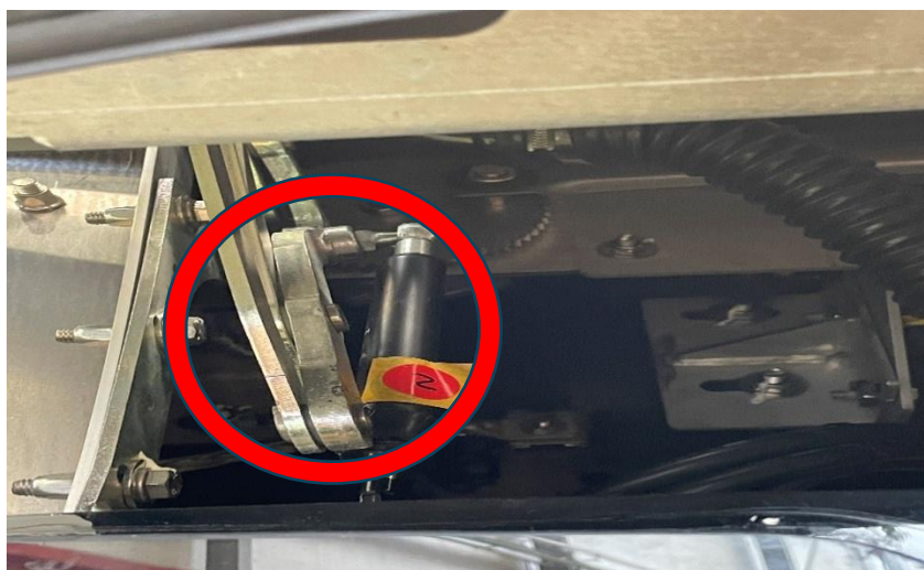
圖 2-9-3 R230 前端車頭蓋干涉，造成不易開啟
