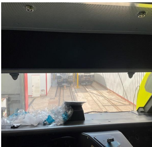
圖 2-16-3 R230 前端遮陽簾未能固定 (已改善)
