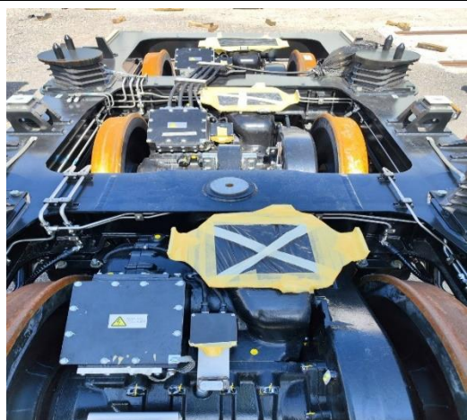
圖 2-17-7 R232 轉向架外露線路及管路需有防護措施(已改善)
