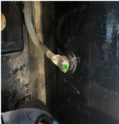
圖 2-12-7 R230 列車防護接地線鬆脫
