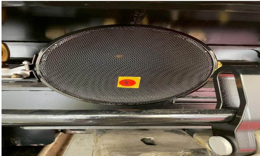
圖 2-8-2 R230 前端喇叭鬆脫未固定
