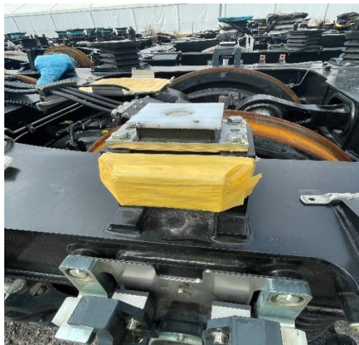
圖 2-17-5 R231 轉向架外露線路及管路需有防護措施(已改善)
