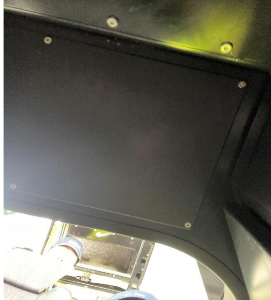
圖 2-6-2 R228 前端助理側下方機蓋遺漏 (已補)
