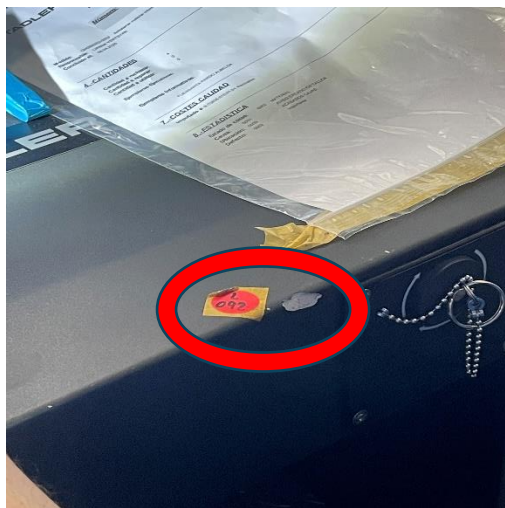
圖 2-12-1 R230 後端駕駛側插頭保護蓋鬆脫
