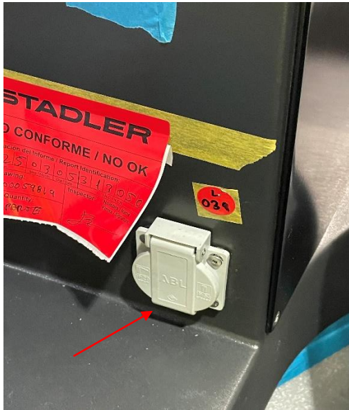
圖 2-12-1 R230 後端駕駛側插頭保護蓋鬆脫
