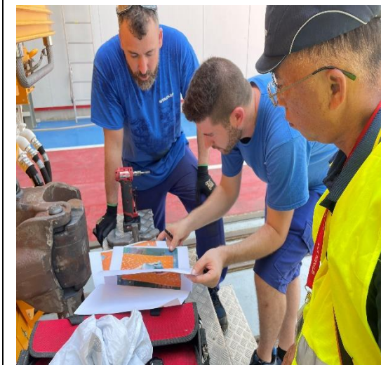
圖 2-4-5 R228 連結器研磨調整
