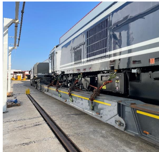
圖 2-7-4 R229 缺失最後確認及監視車輛 上板車情形
