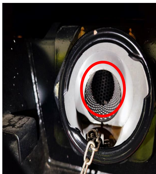
圖 2-5-2 R228 兩側加油孔內側網格方向相反
