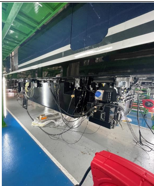
圖 2-14-1 R231 第三站全車電器線路測試
