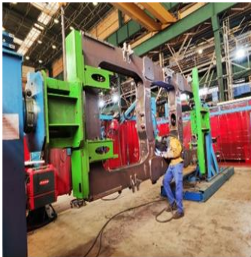
(圖 4-1-4) 焊接氣體做隔離
