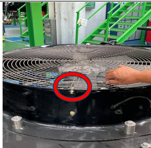
圖 2-11-8 R231 第二風扇護網脫焊
