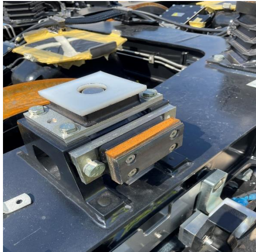
圖 2-17-11 R232 第二轉向架上方止擋生鏽待更換
