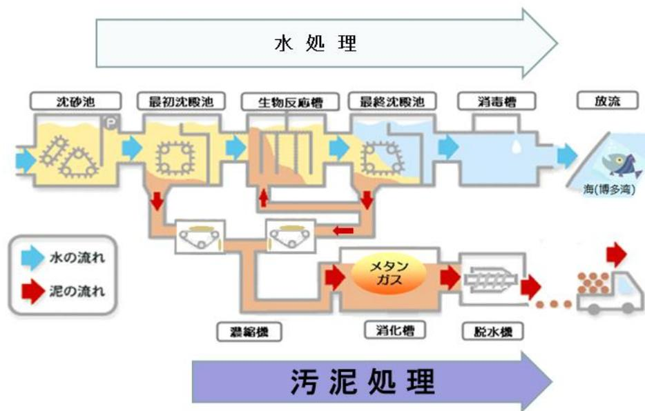
圖 3.4 福岡中部污水處理廠之污水及污泥處理流程
