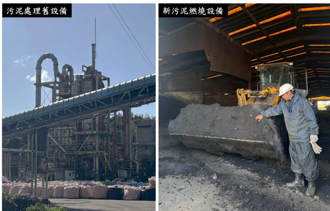
圖 3.44 佐賀下水淨化中心污泥處理新舊設備對照圖
