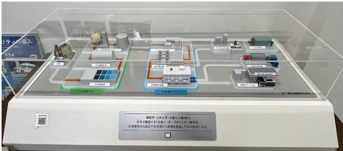
圖 3.6 福岡中部污水處理廠設施模型圖
