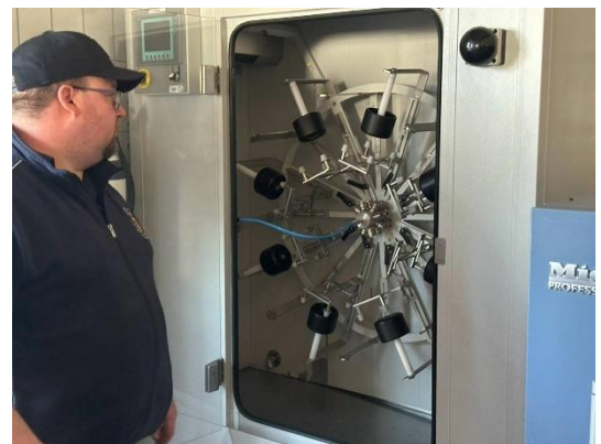
圖 26 雷馬根消防分隊呼吸面罩及肺力閥專用清洗機
