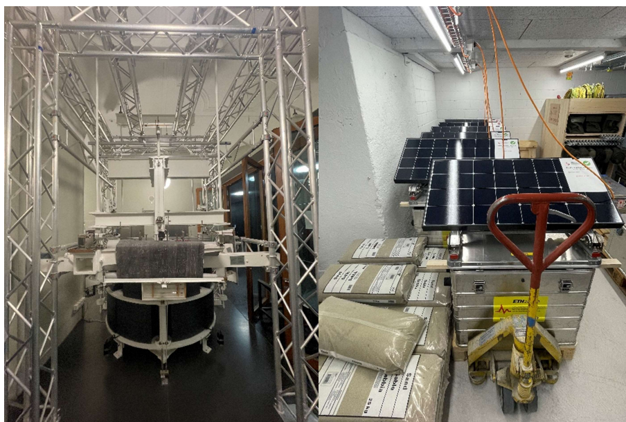
圖 6、ETHZ-SED 地震儀展示。依序為 Nanometric 寬頻地震儀的紀錄器、感測器等設備（左上至右上）、瑞士的 Quervain-Piccard universal seismograph 老地震儀（左下），以及具備太陽能電力供應功能之可攜式地震儀（右下）。此次觀摩展示 ETHZ-SED 從舊世代邁向新世代過程，所採用之地震監測設備。
