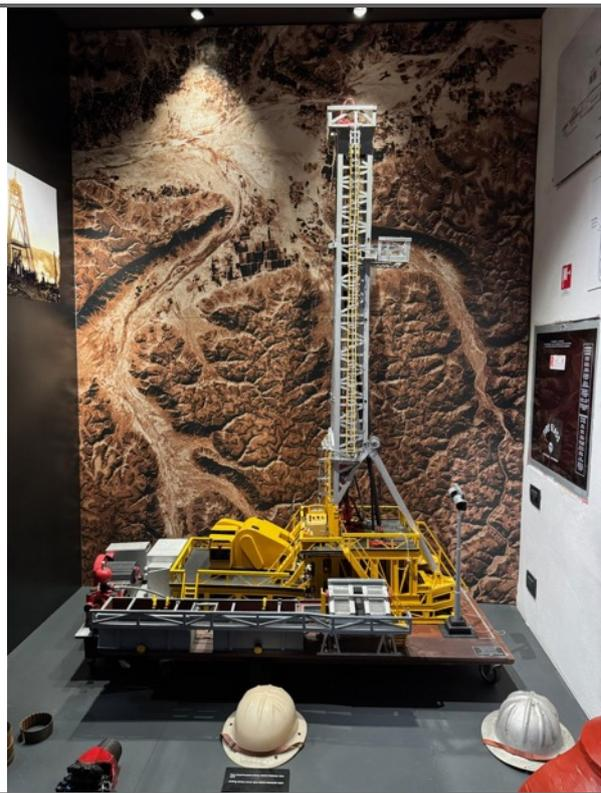
圖 44 現代金屬鑽井設備與過去木造井架時代的對比，展現地熱開發技術的演進。
