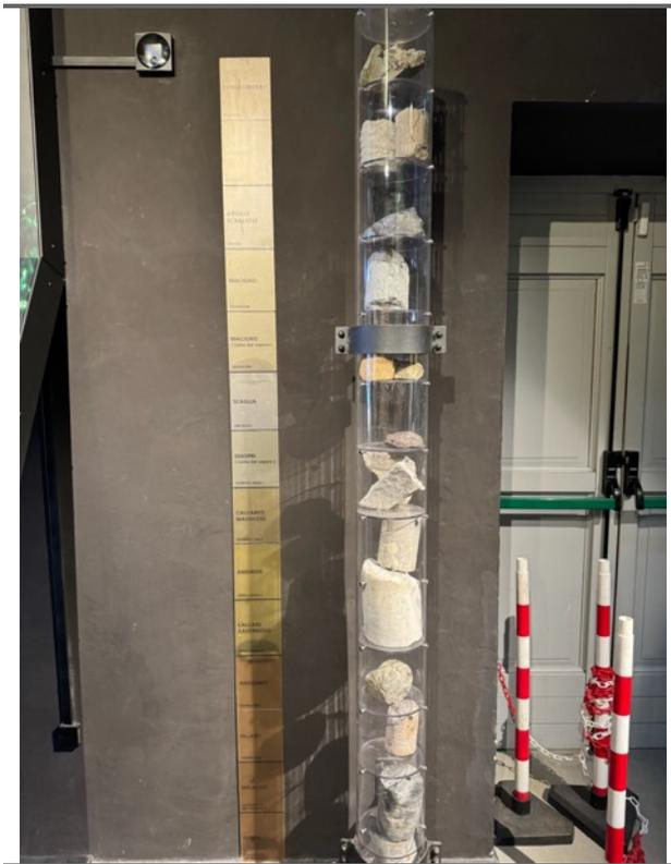
圖 43 鑽井岩心樣本呈現自地表至數千公尺地底的地層構造，是地熱評估與地質研究的重要依據。
