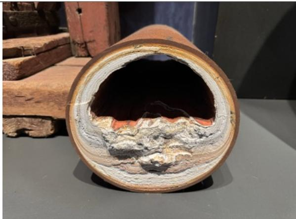
圖 41 因熱水交代作用導致的管線結垢現象，說明地熱系統長期運作所面臨的產能衰減問題。
