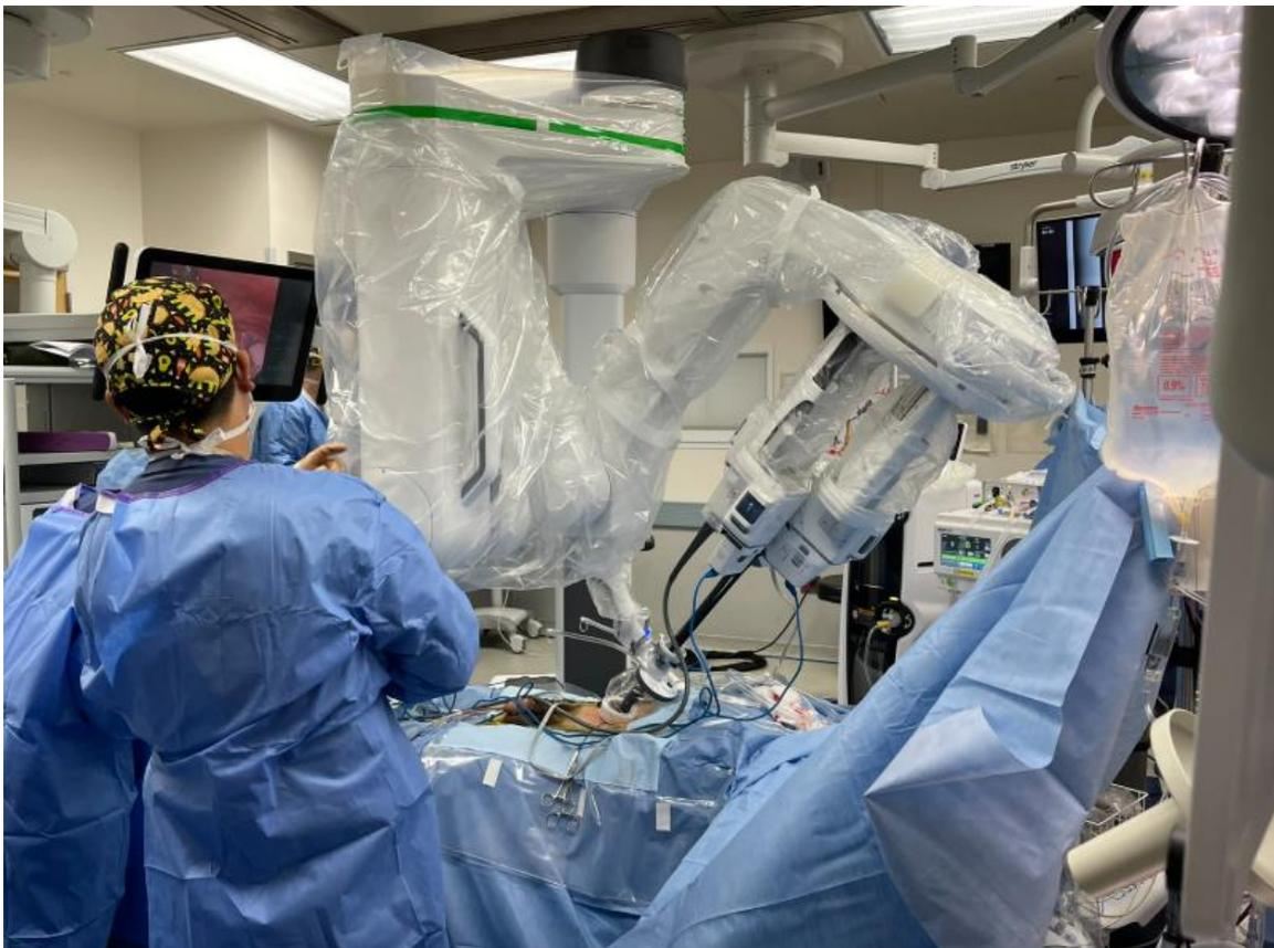
圖八、達文西機器手臂單孔 SP 系統
