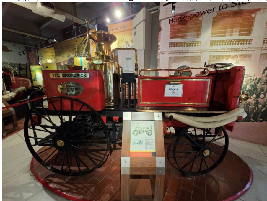
▲ 「THE BROADRICK」消防車，屬於 Merryweather & Sons 公司製造的蒸汽消防車。在內燃機消防車普及之前，是主要的消防工具，其利用蒸汽動力驅動水泵進行滅火。這類消防車在當時代表著先進的消防技術。
