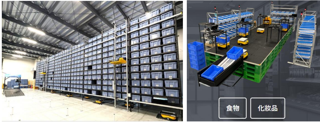
圖 58、AIRROB 立體式料盒自動倉搭配 t-Sort 搬運機器人輸送至播種牆
