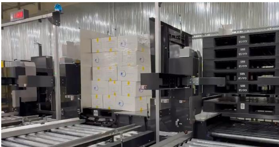
圖 9、棧板交換機作業中
