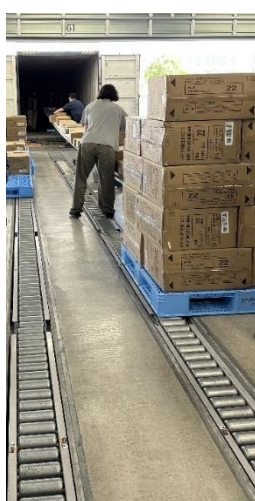
圖 16、運用月台滑軌及延伸滾筒式輸送帶卸櫃
