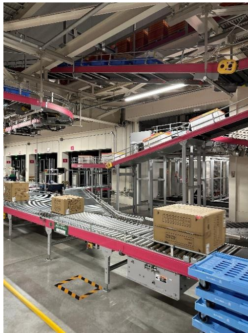
圖 23、複雜的箱入庫輸送帶規劃動線
