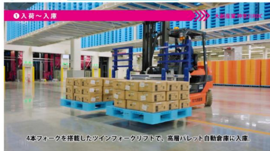
指 中文： 使用配備4支叉臂的雙叉堆高機，將貨物入庫至高層棧板自動倉庫。
