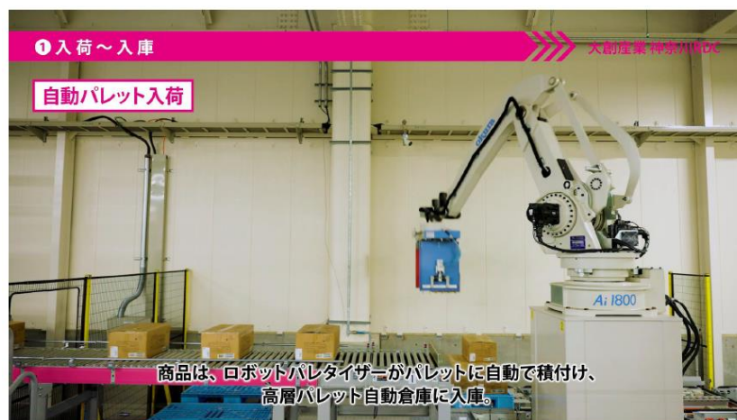
指 中文： 商品由機器人棧板堆疊機自動堆放至棧板上，接著入庫至高層棧板自動倉庫。
