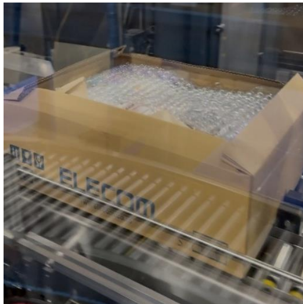
圖 53、標準紙箱送進自動封箱機（透明玻璃隔離）
