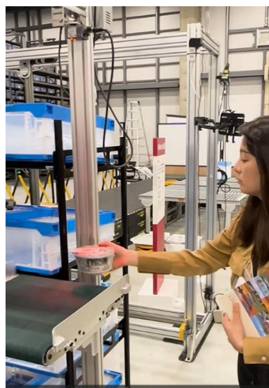
圖 57、播種牆搭配自動移動托盤至對應訂單
