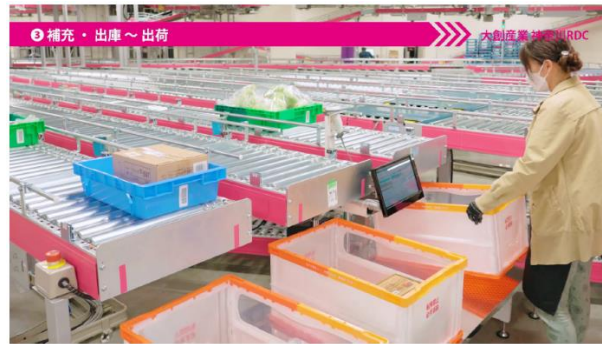
圖 33、物流箱散出貨流程，1 人可同時分揀 3 門市
