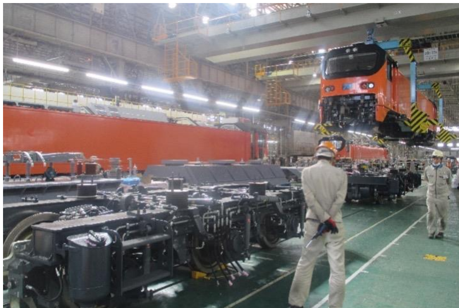
圖 5-6 使用門型吊架治具吊動車輛(2)
