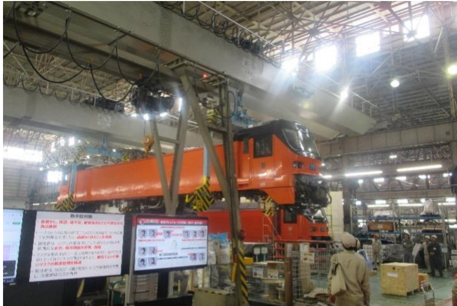
圖 5-5 使用門型吊架治具吊動車輛(1)
