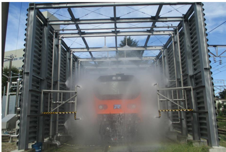
圖 3-5-3-3 E548 水密測試過程
