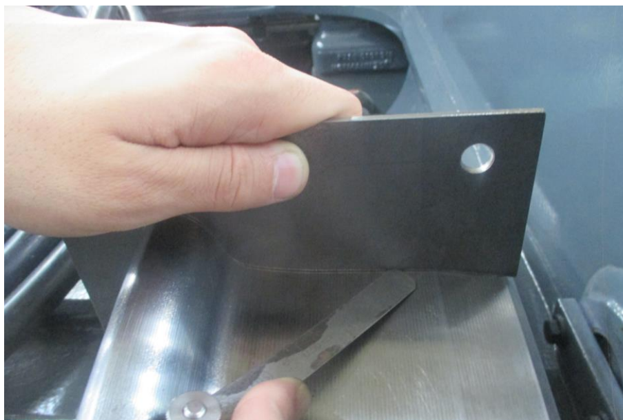
圖 3-2-3-6 檢測車輪踏面形狀
