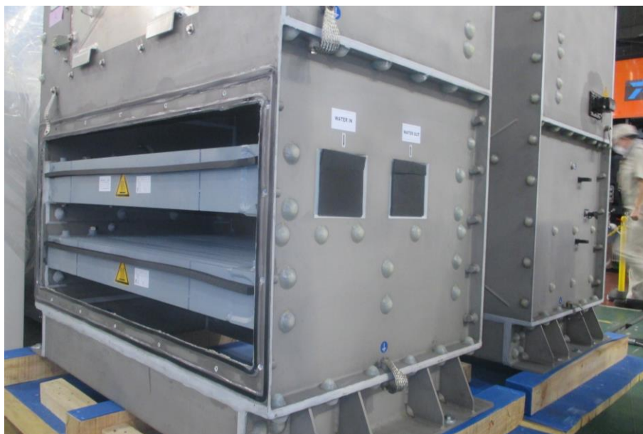
圖 6-5-13 冷卻塔內部散熱器
