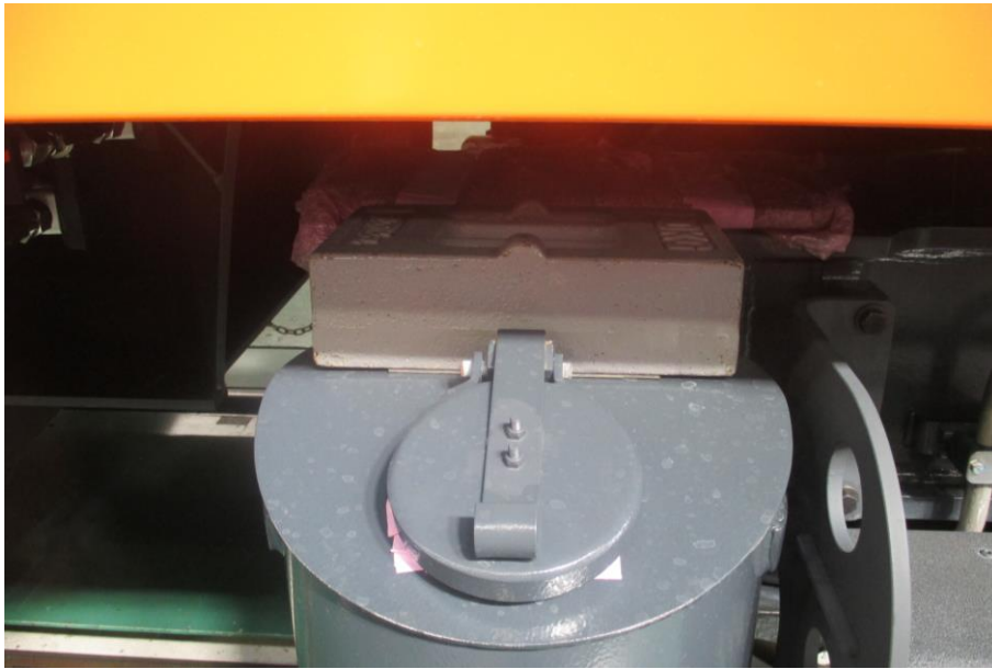
圖 3-1-3-1 沙箱上放置重量塊
