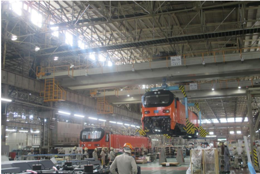
圖 1 東芝 E500 電力機車組裝工廠
