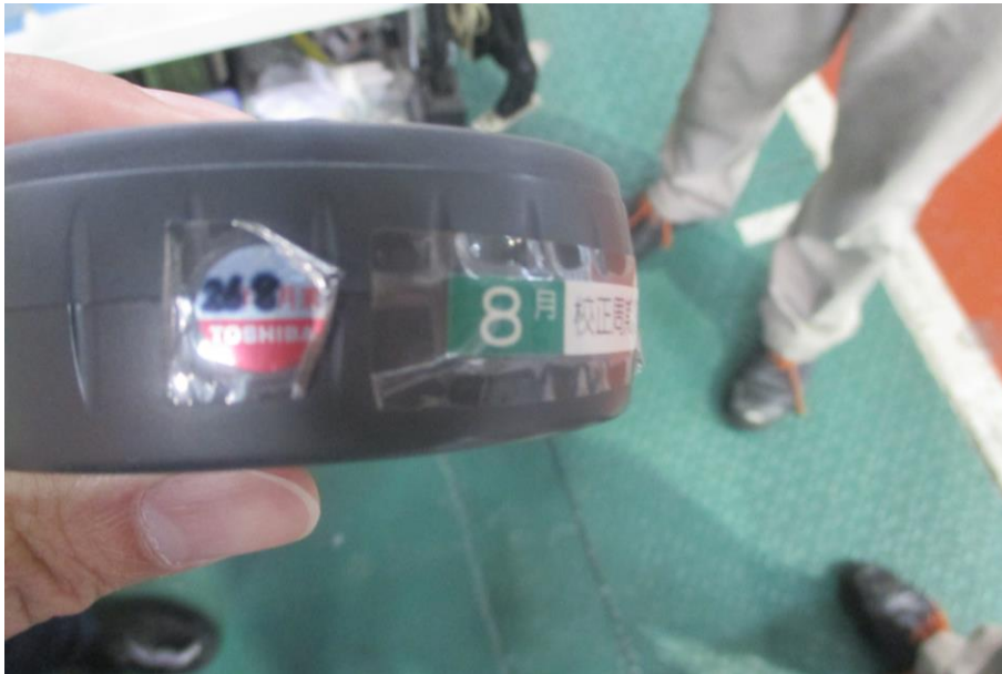
圖 3-3-3-5 膜厚計校正有效日期到 2026.08
