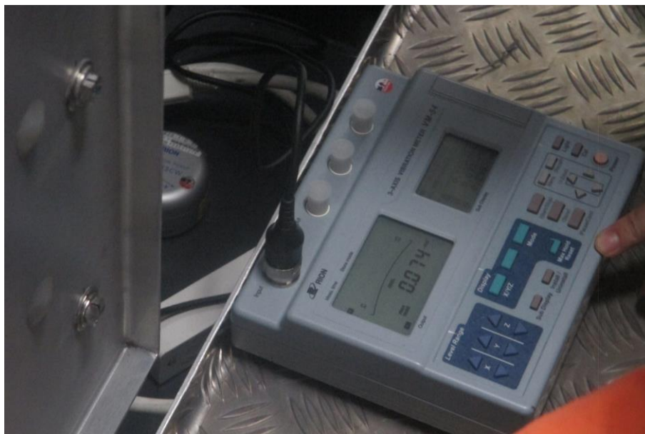
圖 3-4-2-3 量測振動加速度 RMS 數值符合標準
