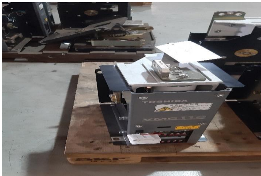
圖 5-14 EMU800 型使用之動力接觸器
