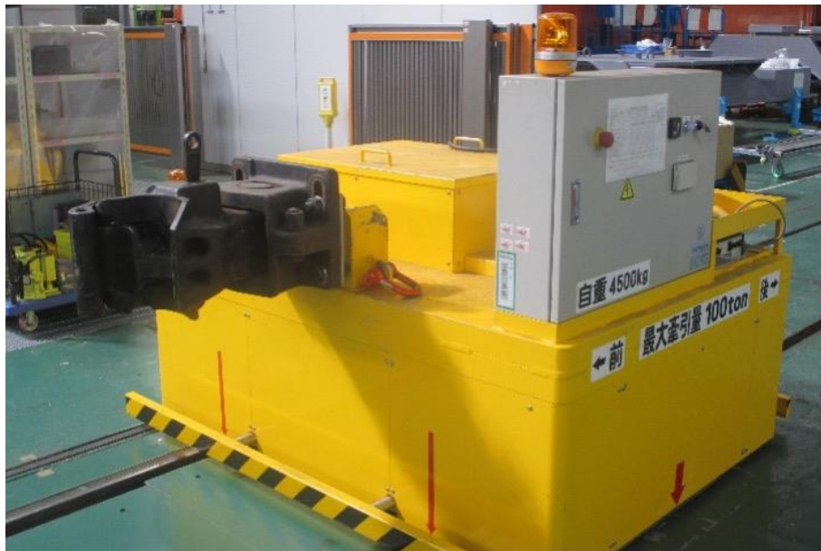
圖 5-3 測試區之軌道式電動調車機(1)
