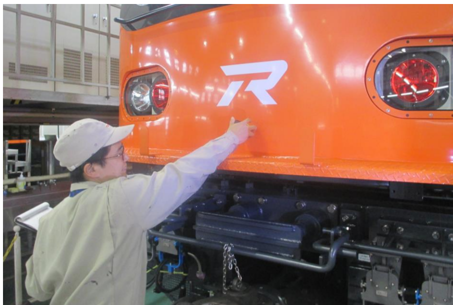
圖 3-3-3-11 E549 駕駛室結構油漆膜厚量測
