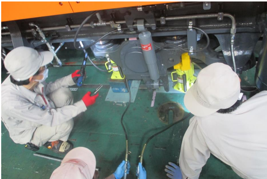
圖 3-1-3-9 使用千斤頂抬升圈簧後，在圈簧下方加裝墊圈
