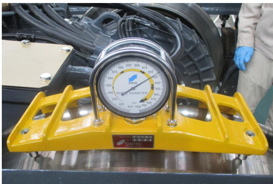
圖 3-2-3-5 量測車輪直徑
