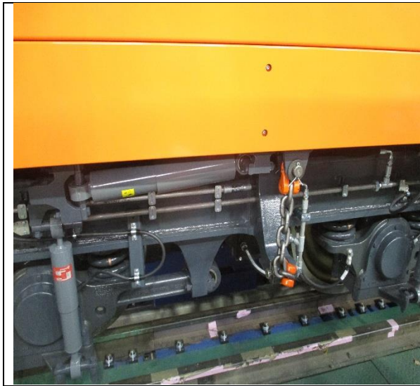
圖 3-3.17 車輛軸重測試中
