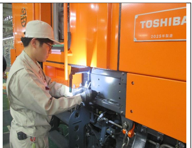
圖 3-3.22 車輛軸重調整
