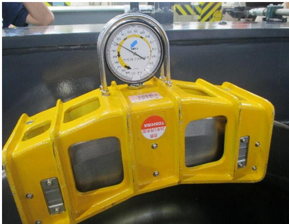
圖 3-3.31 車輪踏面檢視規
