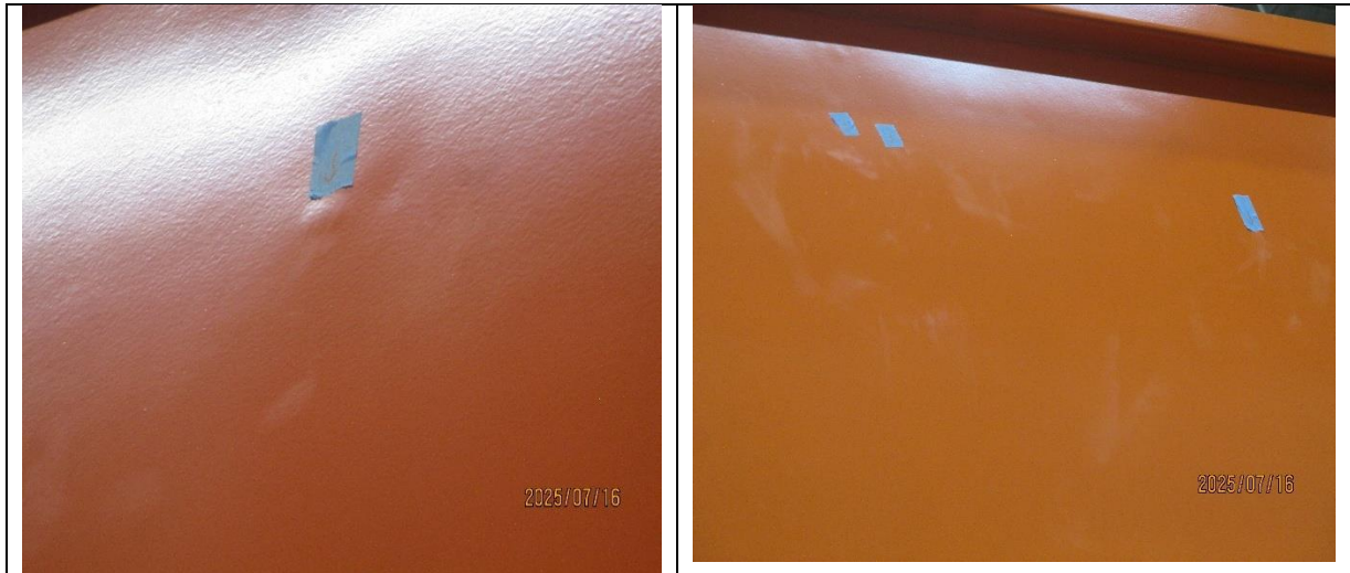
圖 3-3.9 車側不良處所
