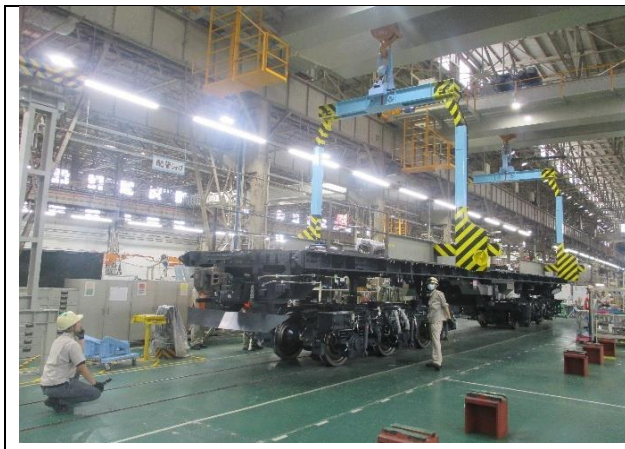
圖 3-1.1 A 工程：車上、車下設備組裝
