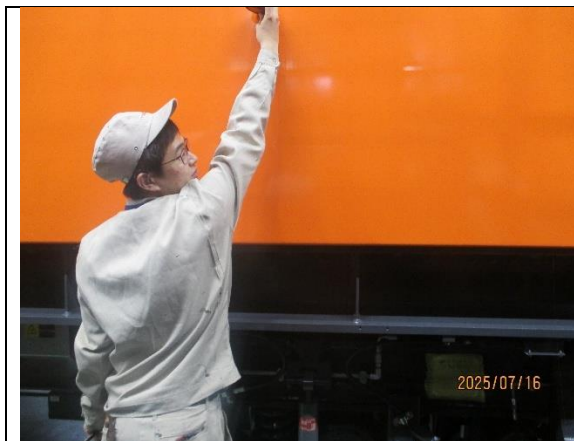
圖 3-3.5 測量機械室側牆油漆厚度
