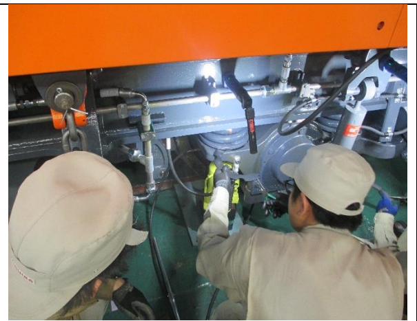
圖 3-3.20 車輛軸重調整
