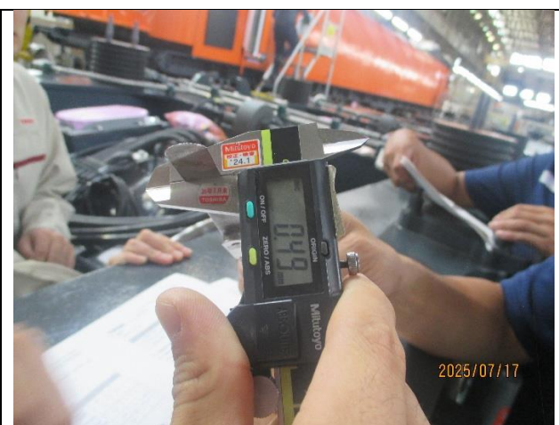
圖 3-3.35 量具標準值量測
