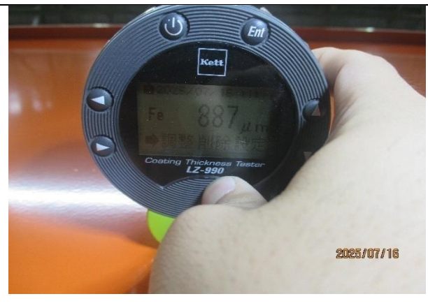
圖 3-3.6 測量機械室側牆油漆厚度數值
