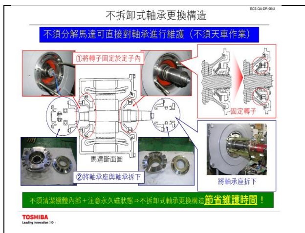
圖 3-4.3 不拆卸式軸承更換構造
