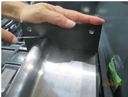
圖 3-5-2-17 踏面輪廓與厚薄規確認量具
