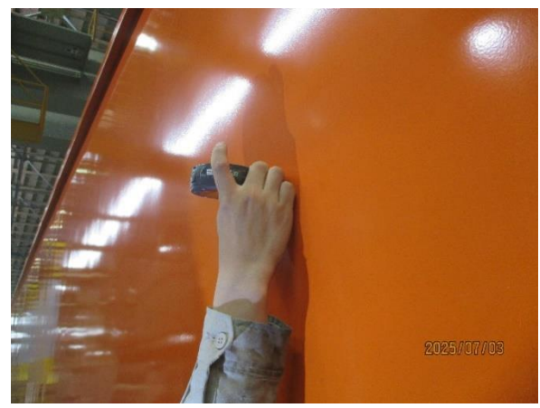
圖 3-4-2-16 膜厚量測點機械室側牆總成
