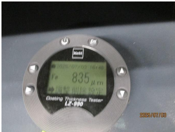
圖 3-4-2-17 膜厚合格標準 120~5350 ( \mu\text{m} ) 位置上
