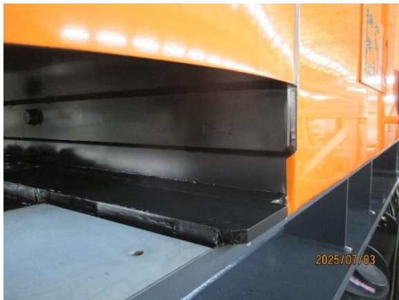
圖 3-4-2-3 檢視 E543 車架結構塗裝
