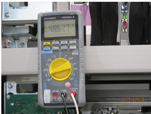
圖 3-6-2-3 確認接點輸出電壓
