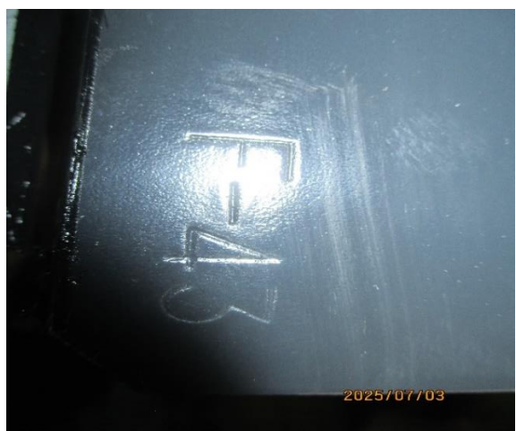
圖 3-4-2-5 E543 車架結構塗裝為煤灰色
