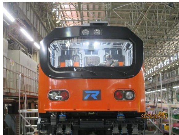
圖 3-4-2-2 檢視 E543 駕駛室前端結構塗裝
