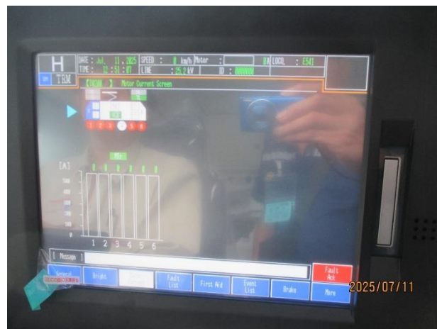
圖 3-7-2-20 切換後退位測試 TM4 出力
