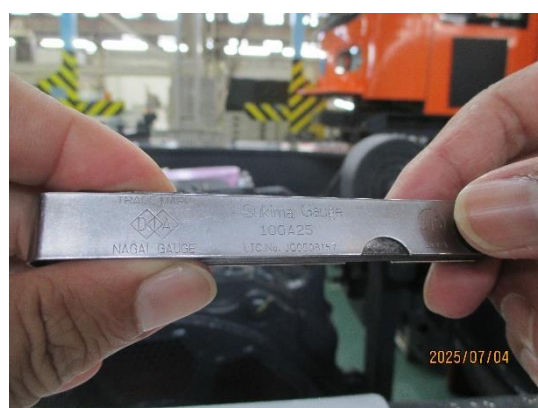
圖 3-5-2-6 厚薄規 採用 0.5mm
