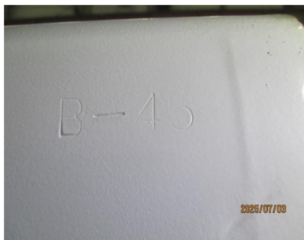
圖 3-4-2-6 檢視塗裝無異常，無外部刮損傷
