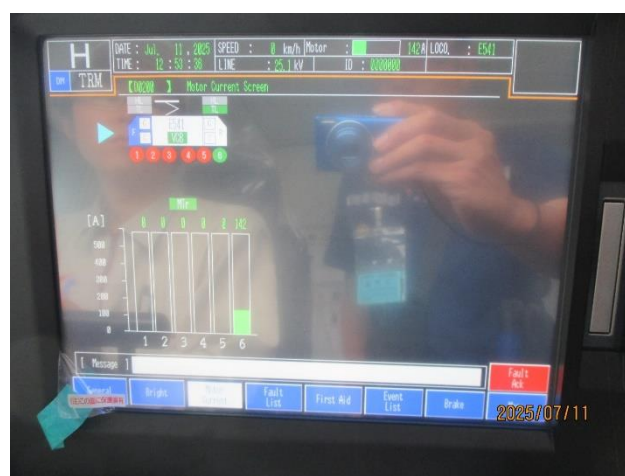
圖 3-7-2-30 後退位 TM6 出力狀況(142A)
