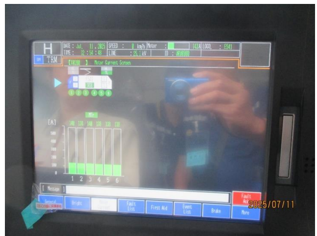
圖 3-7-2-34 後退位 TM1~TM6 共同出力
