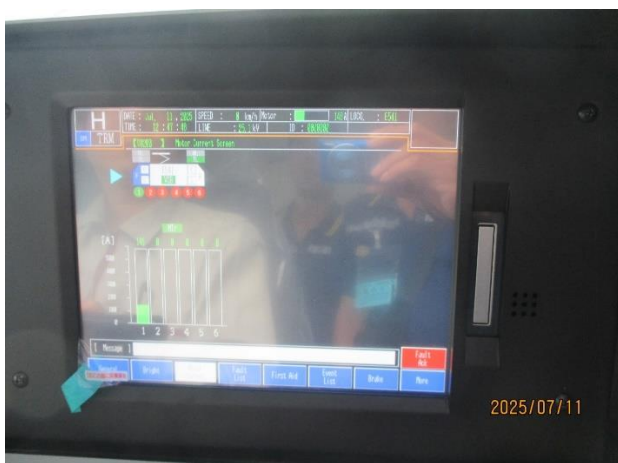
圖 3-7-2-5 後退位 TM1 出力(電流 146A)
