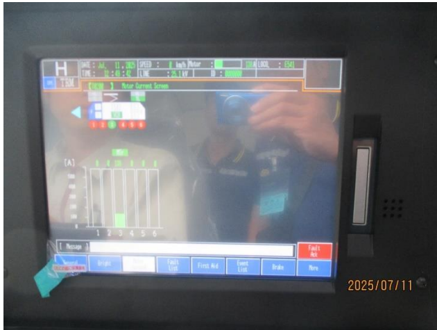
圖 3-7-2-13 前進位 TM3 出力(電流 138A)
