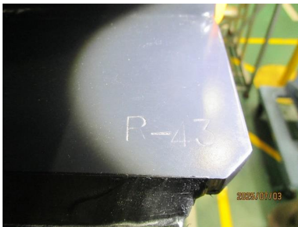
圖 3-4-2-9 檢視塗裝無異常，無外部刮損傷 圖 3-4-2-10 檢視塗裝無異常，無外部刮損傷
