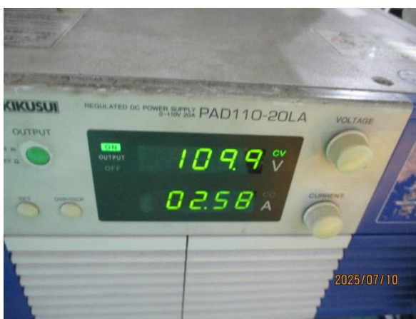
圖 3-6-2-5 確認輸入電壓 110V
