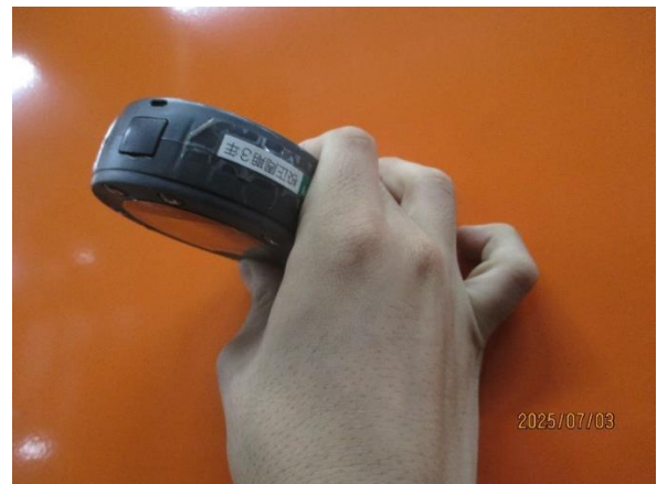
圖 3-4-2-18 將感應器輕輕地按壓在量測 位置上
