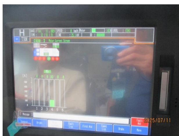
圖 3-7-2-22 TM4 不出力時電流輸出 0A
