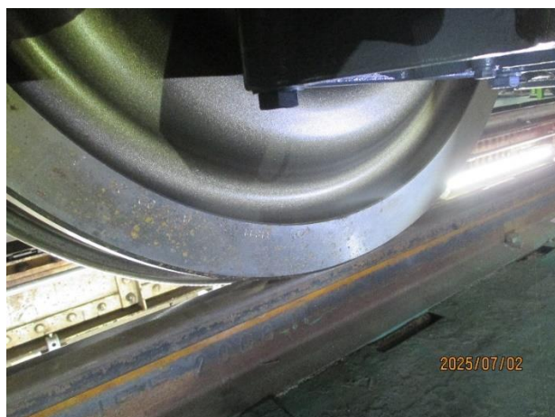
圖 3-3-2-1 以目視或觸摸確認車輪的踏面與輪緣表面的粗度
