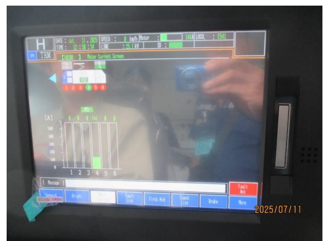
圖 3-7-2-18 前進位 TM4 出力(電流 138A)
