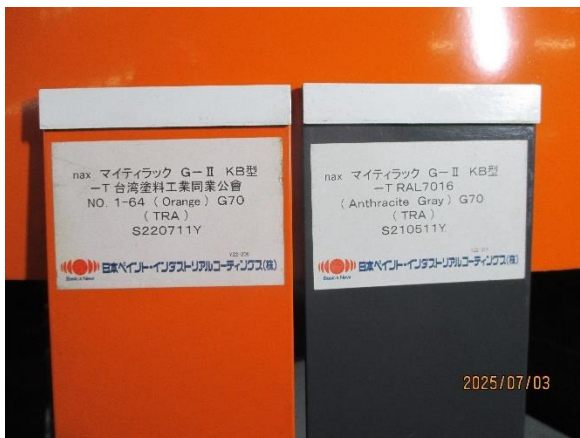
圖 3-4-2-11 依據色卡顯示面漆規格中其光澤度與顏色 圖 3-4-2-12
