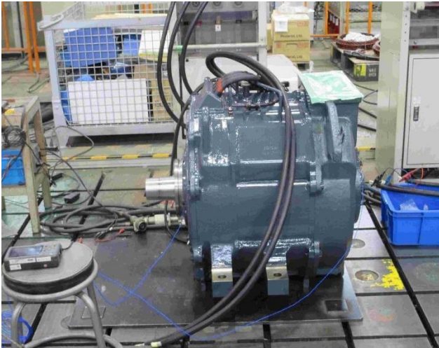
圖 4-7-5-2 (測量和記錄軸承的溫升)
