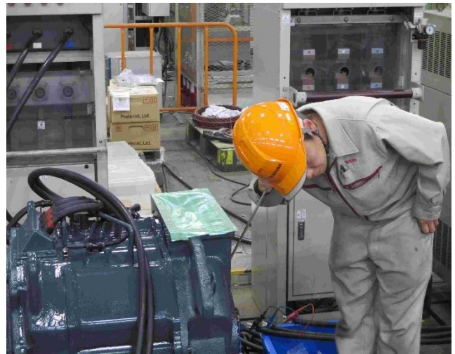
圖 4-7-5-3 (傾聽軸承的聲音)
