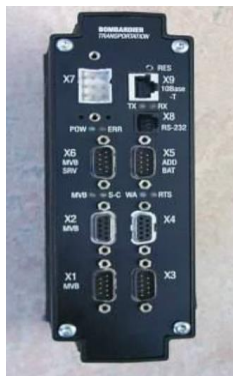
圖 4-8-1-1 (VCU 車輛控制單元)
