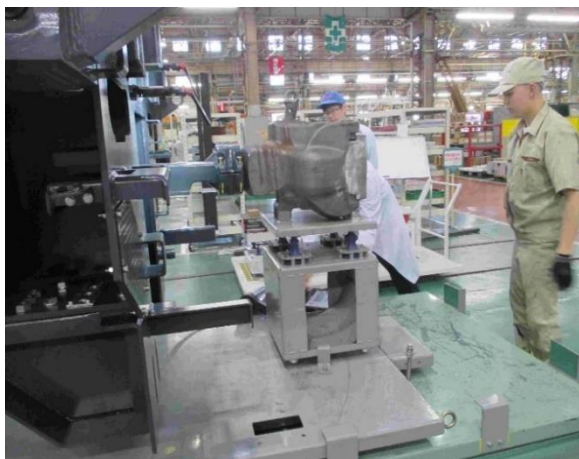
圖 4-3-11-5 (安裝法蘭面與車體架接觸)
