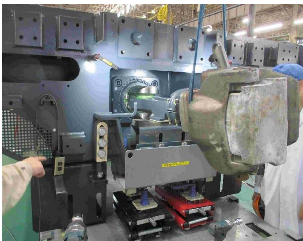
圖 4-3-11-9 (連結器支撐座吊掛(2))
