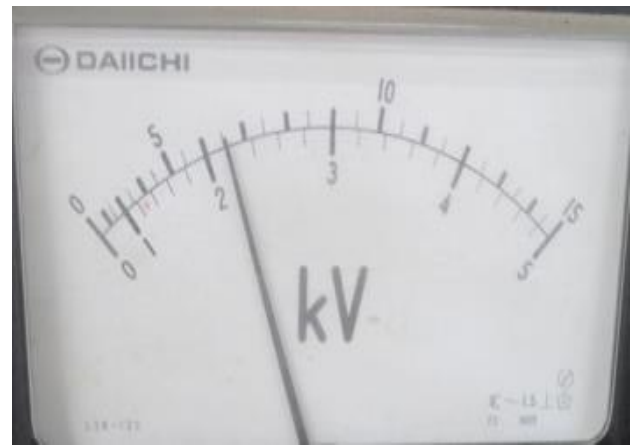
圖 4-7-5-5 (調至 2200V 測量馬達總成一分鐘)
