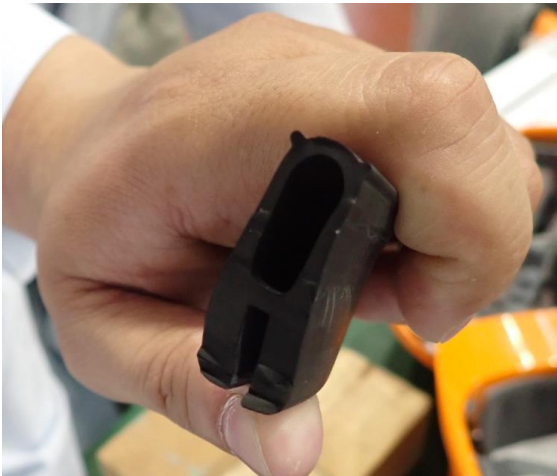
圖 4-1-2-2 (E500 型車頂墊料斷面)
