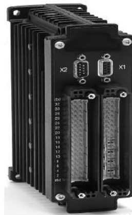
圖 4-8-1-5 (SDU 速度和距離裝置)
