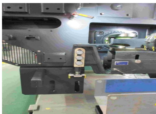
圖 4-3-11-12 (連結器安裝完成)
