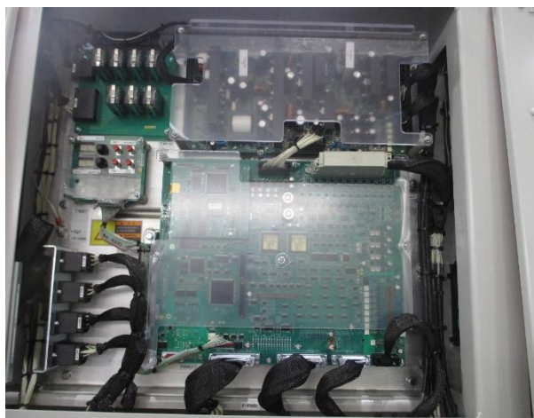
圖 4-5-8-5 (APU/HEP 控制電路版)
