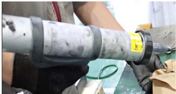
圖 4-1-2-6 (E500 型車體檢修特殊工具:注膠槍)
