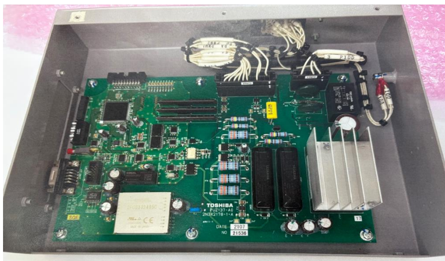
圖 4-6-6-2 (PWM 模組(拆開外蓋))
