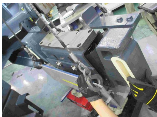
圖 4-3-11-11 (螺絲固定後可放下連結器)
