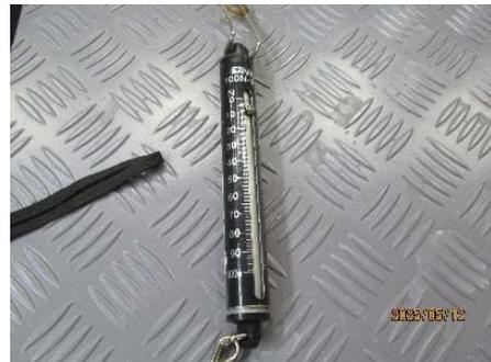
圖 3-3-3-6 集電弓接觸力測試用彈簧秤
