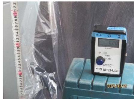
圖 3-8-2-4 量測 XYZ 軸磁通量
