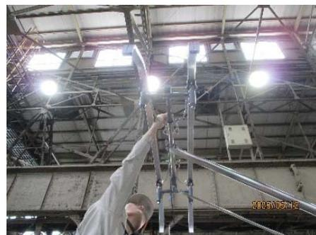
圖 3-3-3-8 集電弓工作高度量測
