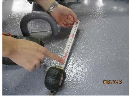
圖 3-4-4-2 電氣間隙測量棉繩 310mm
