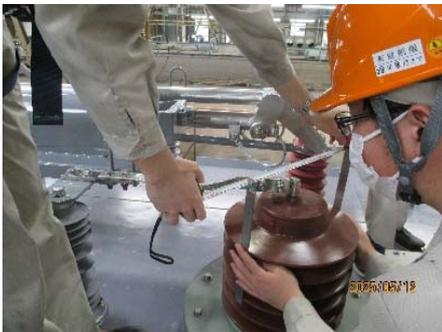
圖 3-4-4-5 測量高壓比壓器爬電距離
