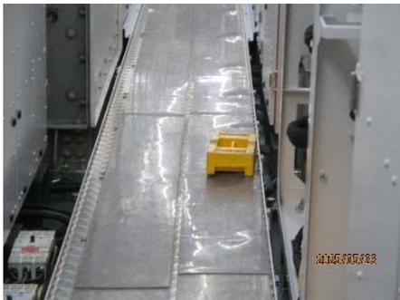
圖 3-1-2-3 放置砝碼模擬滅火瓶重量
