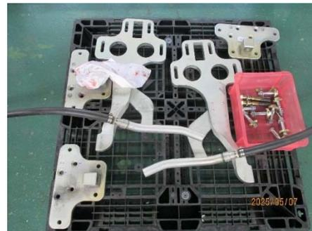
圖 5-2-3-2 輔助排障器及其零組件至於同一棧板上
