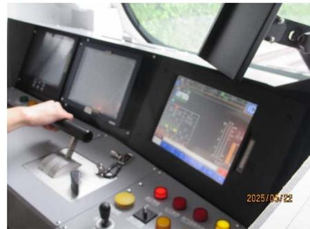
圖 3-5-5-14 推動主控制器確認可出力
