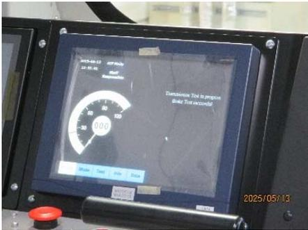
圖 3-5-5-11 後端駕駛室 ATP 開機後執行緊軔測試
