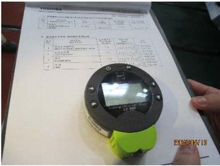
圖 3-7-2-1 油漆厚度測試儀器-膜厚計
