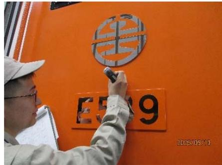
圖 3-7-2-4 量測駕駛室結構油漆膜厚
