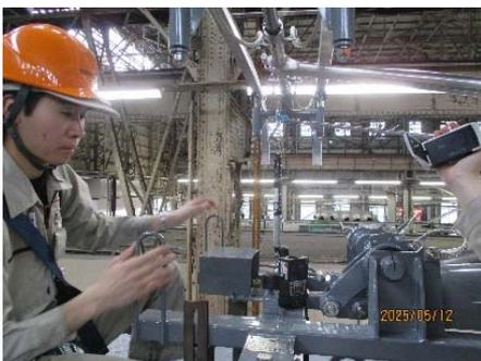
圖 3-3-3-7 集電弓接觸力量測
