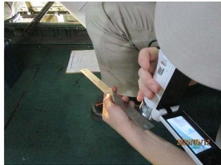
圖 3-5-5-2 CAU 安裝量測儀器-直尺
