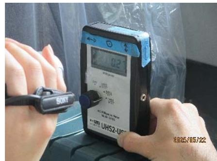
圖 3-8-2-6 量測 XYZ 軸磁通量
