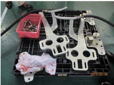
圖 5-2-3-1 輔助排障器及其零組件至於同一棧板上
