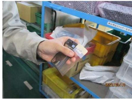
圖 3-7-2-2 膜厚計校正試片
