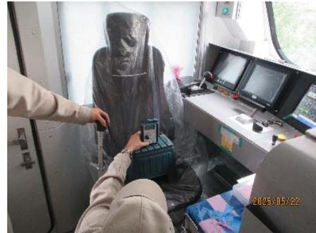
圖 3-8-2-2 設置高斯計至規範高度
