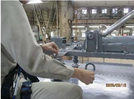
圖 3-4-4-3 使用棉繩量測是否有導電零件
