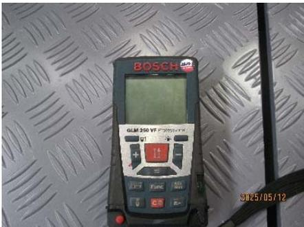
圖 3-3-3-5 集電弓工作高度測試用雷射測距儀
