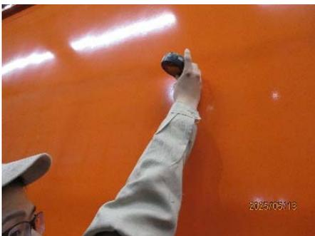
圖 3-7-2-5 量測機械室側牆油漆膜厚
