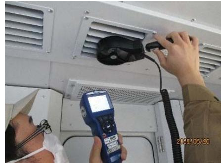
圖 3-6-3-4 使用空氣流量計量測風速
