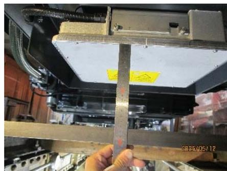
圖 3-5-5-4 量測 CAU 之 T1 的尺寸
