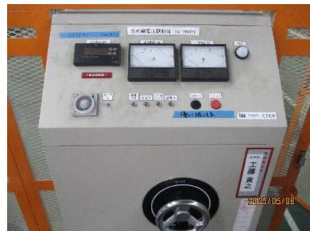
圖 3-2-3-4 測試設備-耐壓測試器
