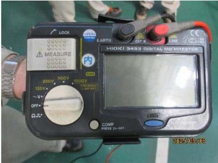
圖 3-2-3-1 測試設備-高阻計
