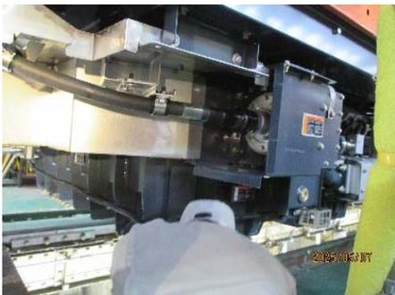
圖 3-4-4-7 檢查主變壓器與高壓穿套連結裝置之防水功能
