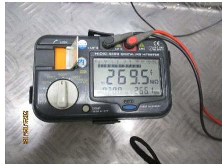
圖 3-2-3-6 ID 1-4 類別 BC 測試結果
