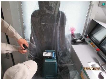
圖 3-8-2-5 量測 XYZ 軸磁通量
