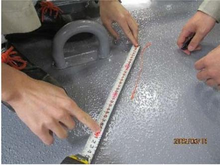
圖 3-4-4-1 電氣間隙測量棉繩 230mm
