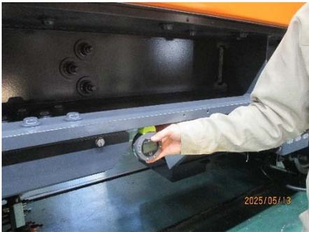
圖 3-7-2-3 量測車架油漆膜厚
