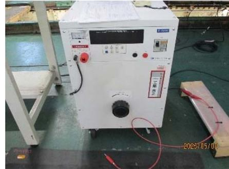
圖 3-2-3-2 測試設備-耐壓測試器
