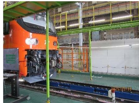
圖 3-1-2-4 將車輛推至量測設備
