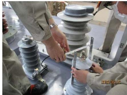
圖 3-4-4-6 測量高壓穿套爬電距離
