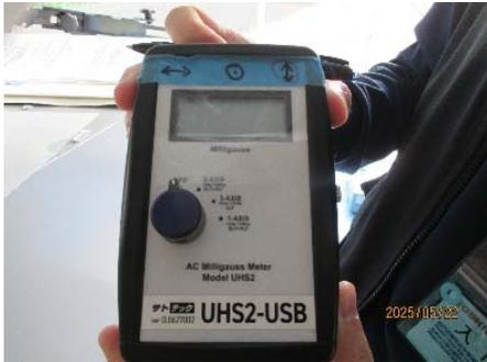
圖 3-8-2-1 電磁波量測儀器-三軸磁向量/等級高斯計
