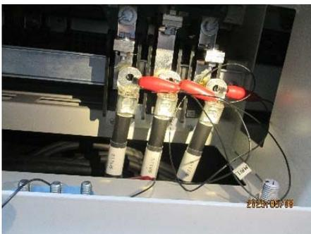
圖 3-2-3-3 類別 A3 輔助電路測試接線
