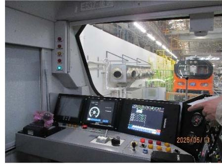
圖 3-5-5-10 後端駕駛室 ATP 開機啟用
