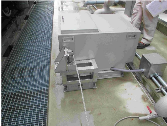
圖 3-27: 水密測試時，負責移動車輛的絞盤
