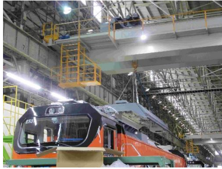
圖 3-38:車頂安裝工程
