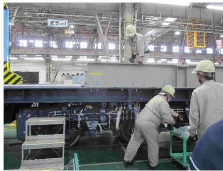
圖 3-35:駕駛室及側牆結構安裝工程
