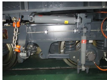
圖 4-1-7-9 移除橫向液壓減震器
