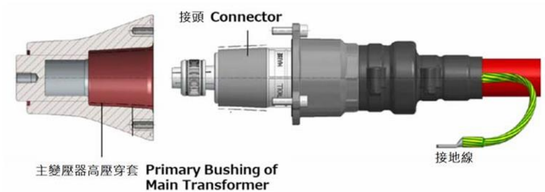
圖 4-3-3-3 變壓器 25KV 接頭
