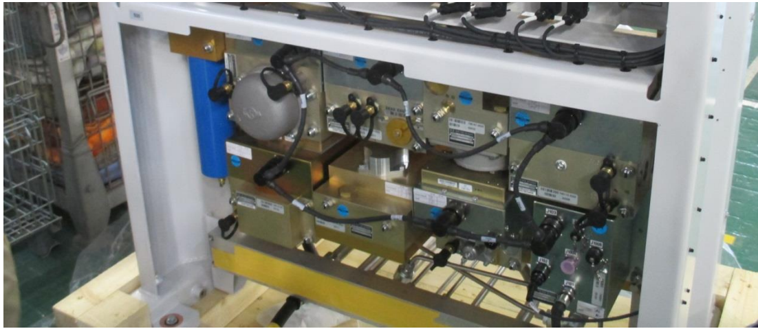
圖 4-4-2-6 EPCU 電空控制單元
