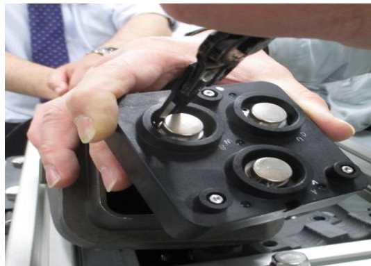
圖 4-5-5-30 卡扣拆解實作
