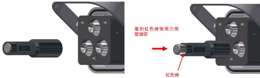
圖 4-5-5-3 YL14-6 型插座活動式接觸片(大)拆解
