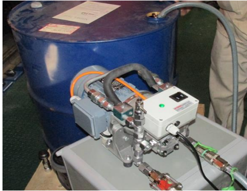
圖 4-3-5-18 注油裝置泵浦
