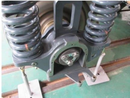
圖 4-1-7-6 轉向架移除軸箱
