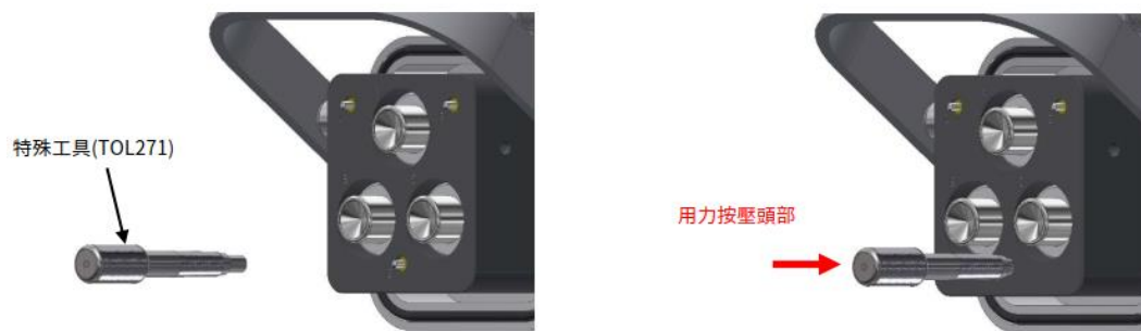
圖 4-5-5-7 L14-6 型插座活動式接觸片(小)拆解
