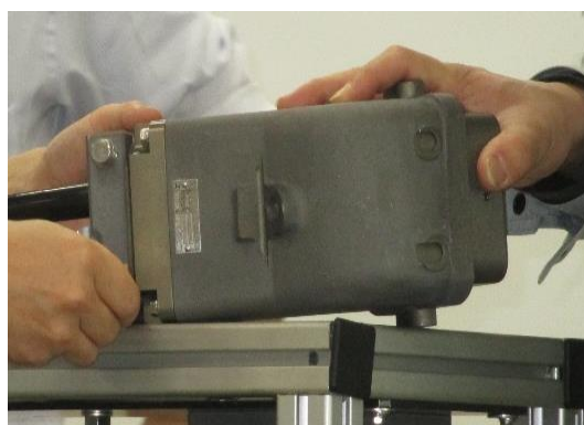
圖 4-5-5-22 上下電線夾拆解實作
