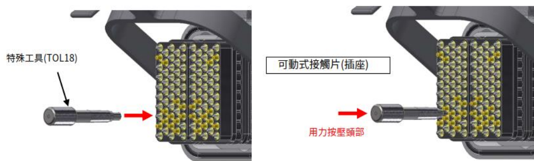
圖 4-5-5-10 YL11S-96IJ 插座活動式接觸片拆解
