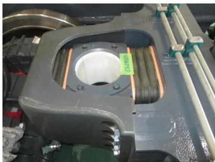
圖 4-1-7-10 拆解牽引中心總成
