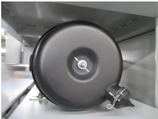
圖 4-2-1-9 乾式空氣過濾器
