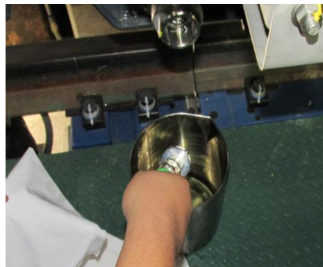
圖 4-3-5-13 確認管路空氣排空
