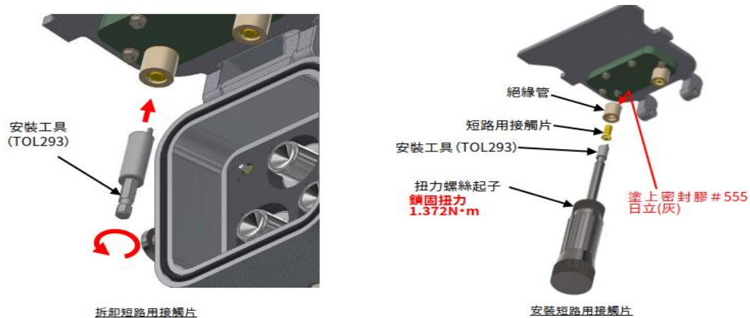
圖 4-5-5-16 絕緣管的拆解說明
