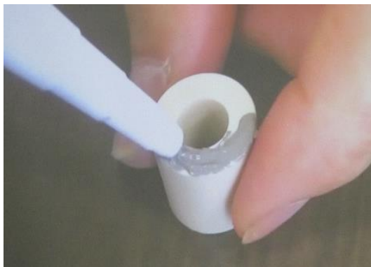
圖 4-5-5-17 絕緣管安裝塗膠
