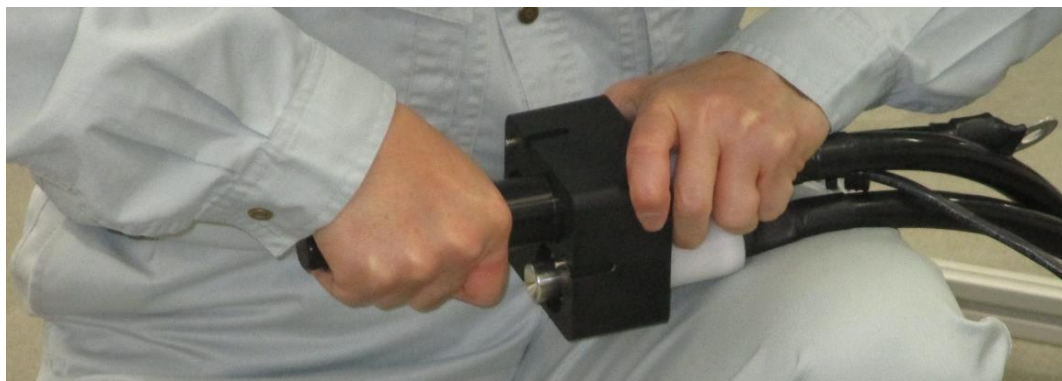
圖 4-5-4-4 YL14-6 型插座活動式接觸片(大)拆解實作
