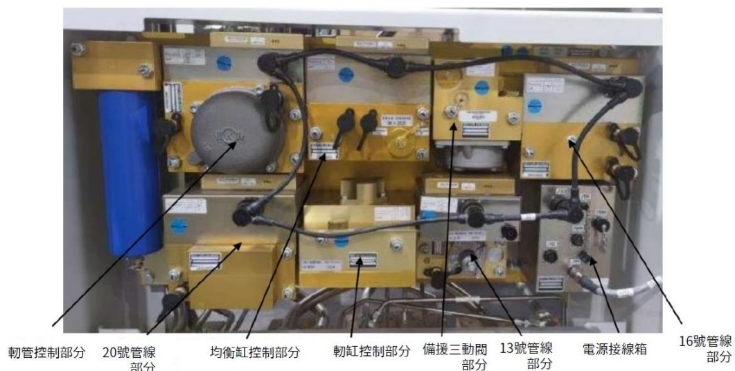
圖 4-4-2-5 EPCU 電空控制單元
