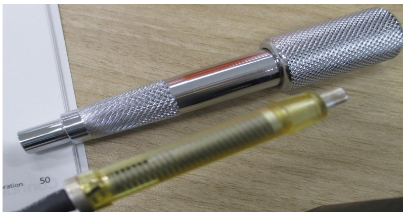
圖 4-5-5-12 YL11S-96IJ 插座活動式接觸片及拆卸制具
