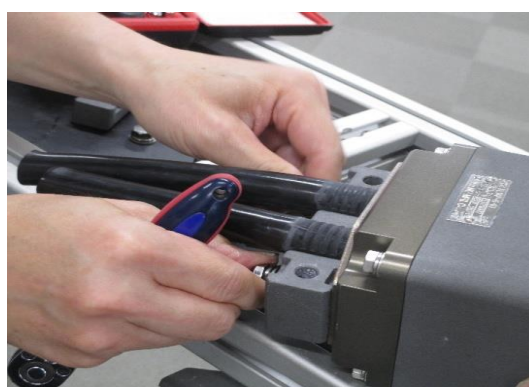
圖 4-5-5-24 電線夾拆解實作
