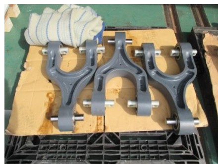
圖 4-1-7-4 移除引導桿更換球型襯套
