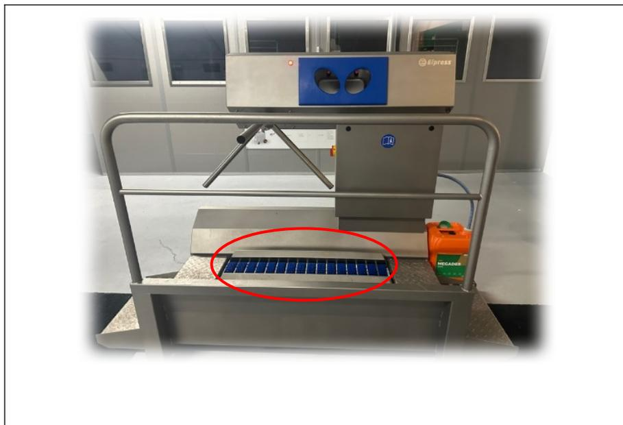
圖二十八、Elpress 的衛生控制系統，紅色圈起部分為鞋底清洗刷，腳踏上去會自動旋轉清洗及消毒，藍色區域為手部消毒器，必須兩手伸入進行消毒。
