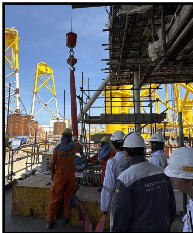
圖 14 吊車(1500kg)荷重(1650kg)測試
