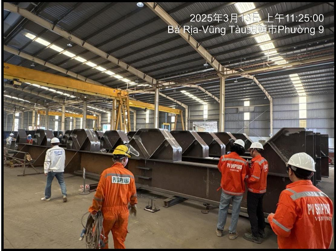
圖 22 海上變電站駁船鋼管樁支撐格柵
