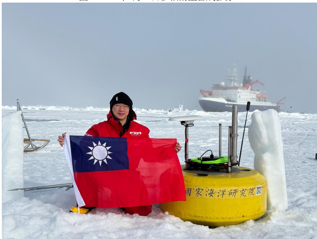
圖16 本院同仁於 R2海冰測站成功布放臺灣自製表面浮標掛載海流儀，進行海洋上層180公尺長時間海流剖面量測。
