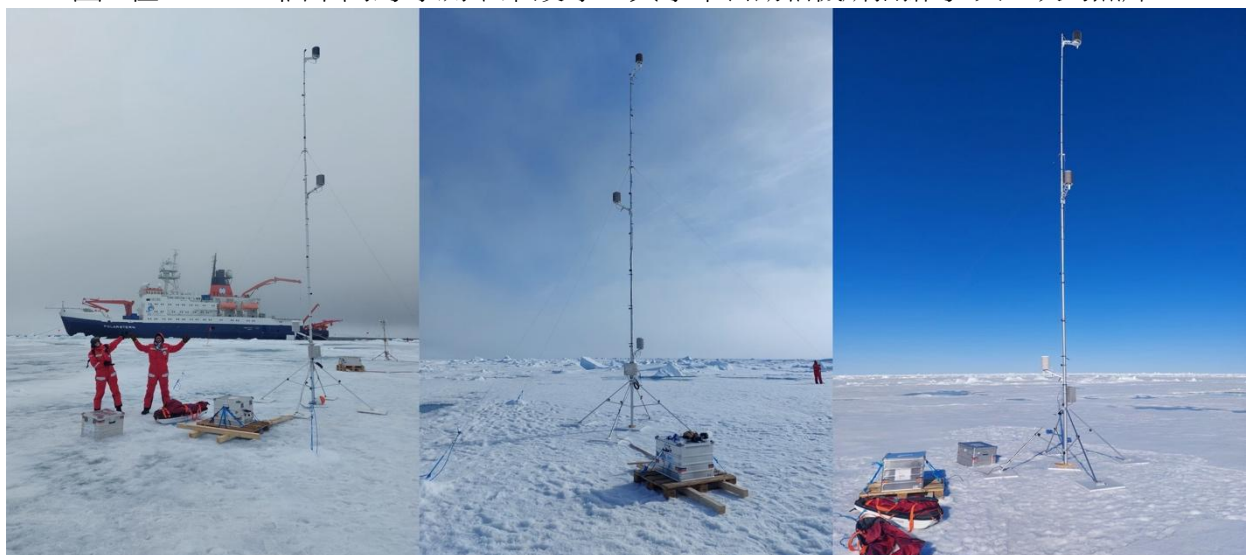
圖8 海冰表面大氣自動能量收支平衡10米觀測塔，由左至右分別為 R1、R2、R3海冰測站設置情況。
