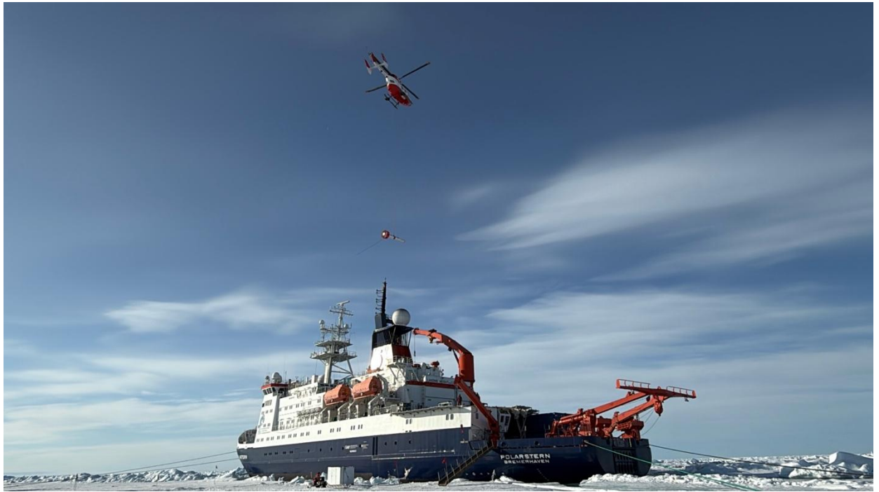
圖13 透過直升機掛載磁力儀進行海冰周邊磁場變化與海冰厚度量測。
