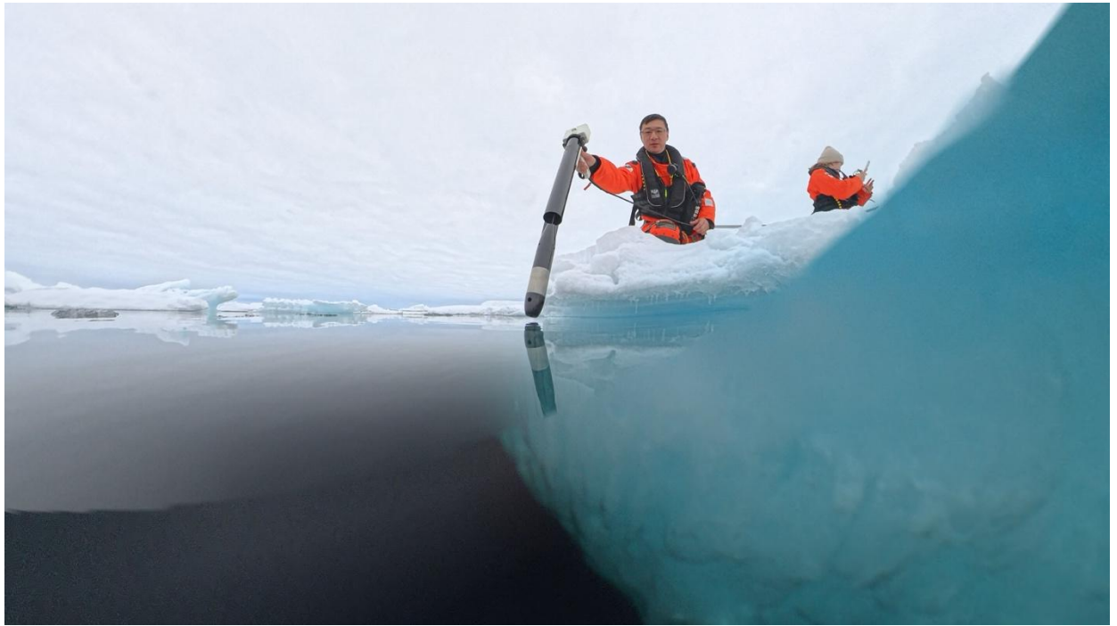
圖19 本院同仁搭乘直升機至海冰測站周邊進行 XCTD 溫鹽剖面量測。
