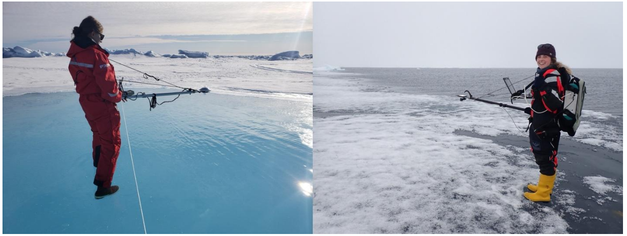
圖 11 海冰上進行(左)表面反照率量測儀(右)表面輻射儀。
