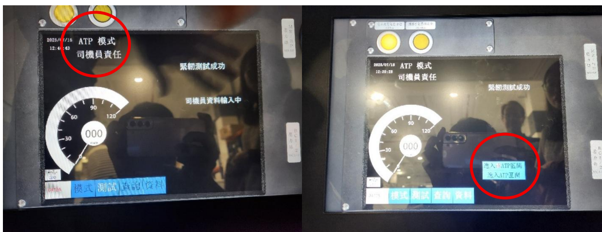
▲圖 9（左）：ATP 開機後尚未輸入資料時直接跳到司機員責任模式。圖 10（右）：選擇進入 ATP 區間時點選「V」，顯示「進入非 ATP 區間」選項。
