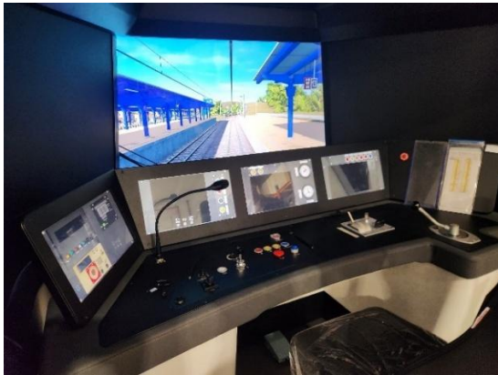
▲圖左：駕駛模擬器組裝並運作中成品，包含顯示之 55 吋正液晶螢幕、副螢幕。 圖右：教官台示意圖，包括主機、列表機、4 台 27 吋液晶螢幕、鍵盤滑鼠組。
