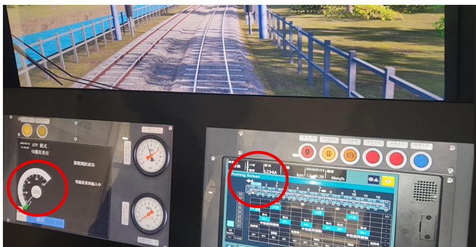
▲圖 20：車門開啟未隔離 ZVRS，車速超過 5 km/H，車門不會自動關。
