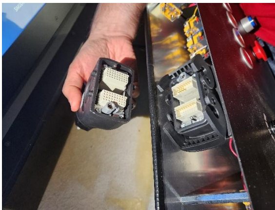
▲圖左：快拆面板底下之接頭，有防呆設計。圖右：快拆面板下方有設計橡膠鋪設，不僅防滑亦有防撞功效。
