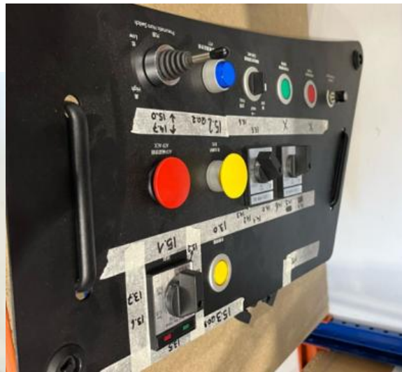
▲圖左：EMU3000 型電聯車快拆式控制面板。圖右：EMU900 型電聯車快拆式控制面板。兩者面板均可輕易拆卸。
