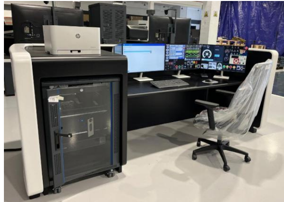
▲圖左：駕駛模擬器組裝並運作中成品，包含顯示之 55 吋正液晶螢幕、副螢幕。 圖右：教官台示意圖，包括主機、列表機、4 台 27 吋液晶螢幕、鍵盤滑鼠組。
