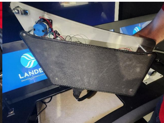
▲圖左：快拆面板底下之接頭，有防呆設計。圖右：快拆面板下方有設計橡膠鋪設，不僅防滑亦有防撞功效。
