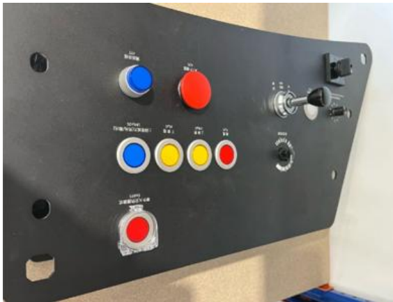
▲圖左：EMU3000 型電聯車快拆式控制面板。圖右：EMU900 型電聯車快拆式控制面板。兩者面板均可輕易拆卸。
