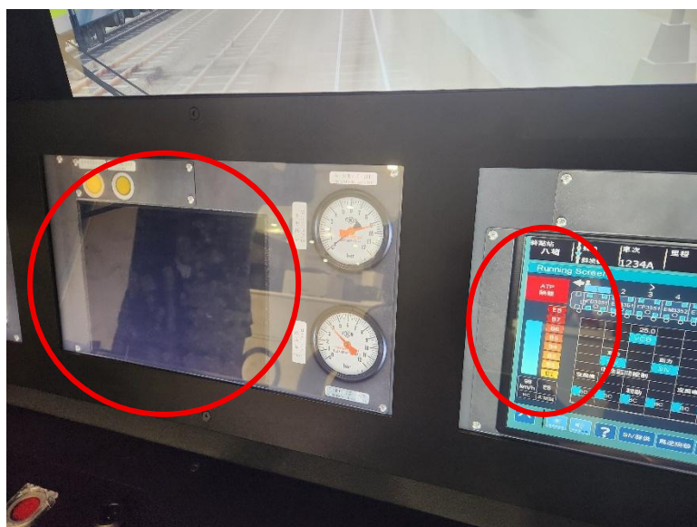
▲圖 21：ATP 關機後 TCMS 電門可以超過 60 km/H。
