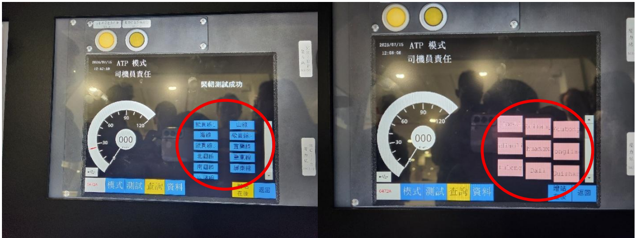
▲圖 12（左）：點選「停靠站查詢」功能後，跳出顯示站名的路線別目錄。圖 13（右）：「停靠站查詢」功能之停靠站清單顯示為英文。
