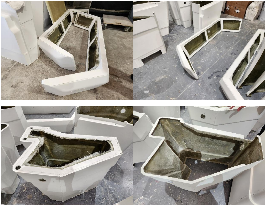
▲左上：模擬器車上顯示螢幕外殼未磨去毛邊前。右上：模擬器車上顯示螢幕外殼磨去毛邊後。左下：模擬器駕駛台支柱外殼未磨去毛邊前。右下：模擬器駕駛台支柱外殼磨去毛邊後。
