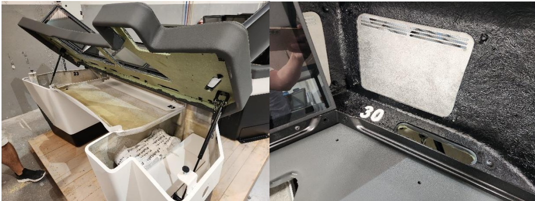
▲圖左：駕駛模擬器平台可以掀起以便更換零件或維修，並附有油壓頂桿，兼顧省力與安全。圖右：外殼上的編號顯示第 30 組模擬器的外殼已完工。
