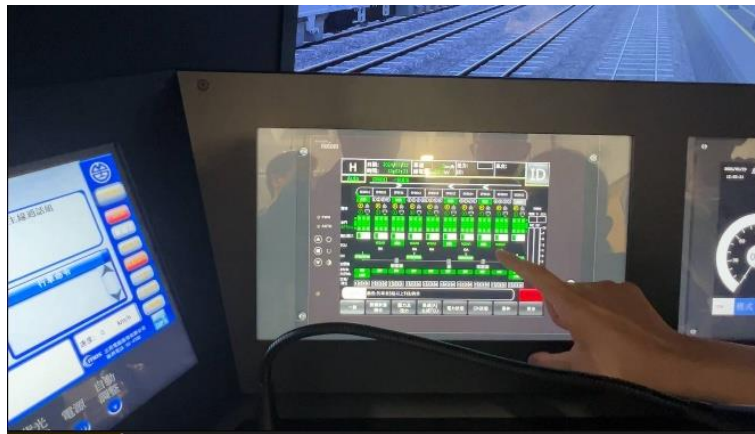
圖 9 電車線電壓正常，VCB 閉合
