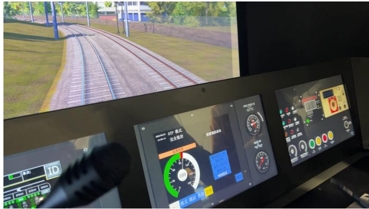
圖 46 列車超速時 ATP 系統介入作用
