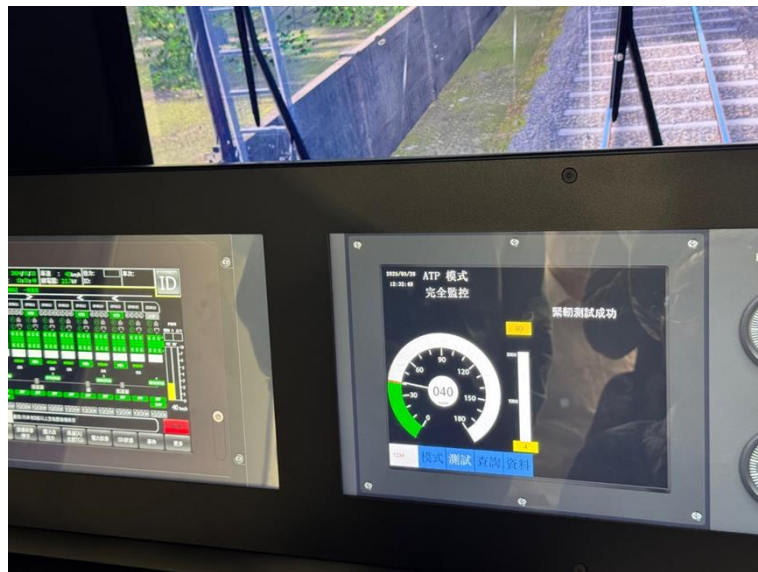
圖 42 遇緩速號誌機系統限速 40 km/h
