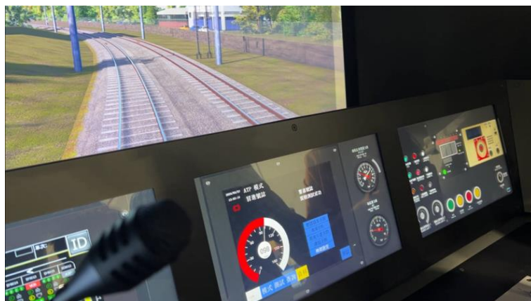
圖 47 列車超速時 ATP 系統顯示冒進號誌
