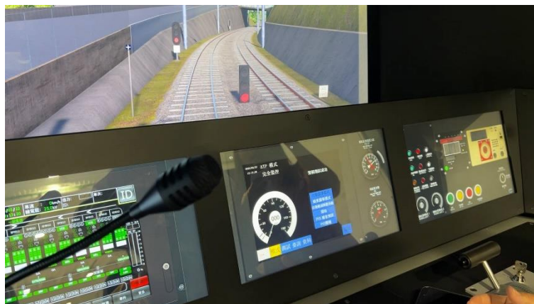
圖 45 閉塞號誌機顯示險阻號誌時，ATP 壓制速度為 15 km/h
