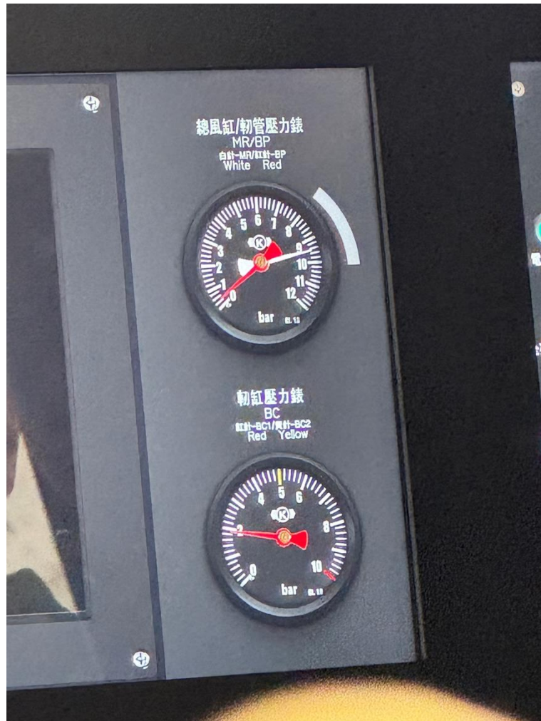
圖 30 總風缸、軔管與軔缸壓力表
