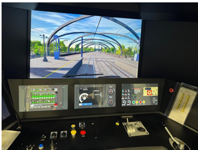
圖 43 司軔閥隔離位且列車時速 2 公里(溜逸)未觸發緊急緊軔
