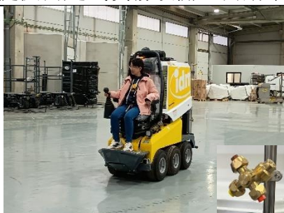
圖36、IDM 專為溫室、網室及大型隧道式設施開發的直立式噴霧設備，具備高壓均勻噴霧、可調流量噴頭(3段式)、定速與定壓控制，及專利6×6驅動系統，適應各種地形，最小作業空間為75 cm，且依地形與需求可選配不同寬度的底盤和輪胎，以確保噴灑效果一致
