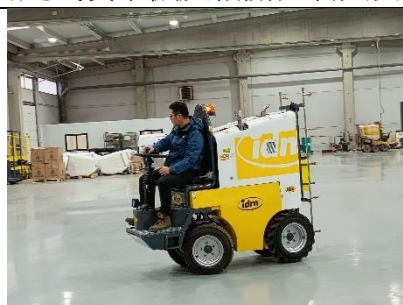
圖37、四輪驅動機型，同樣具備具備高壓均勻噴霧、可調流量噴頭(3段式)、定速與定壓控制，適用於中型農場
