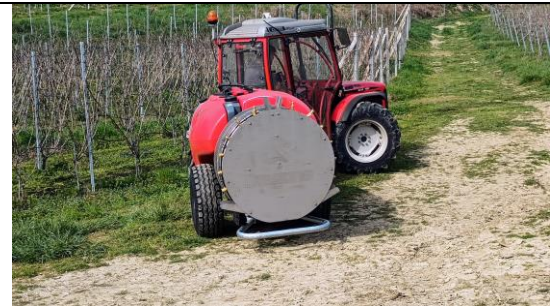
圖63、Dragnoe 開發之高壓噴霧機，噴頭模組可快速拆卸更換，維修便利，亦有搭載趕測模組可依據作物高度及風速調整噴幅之機型。
