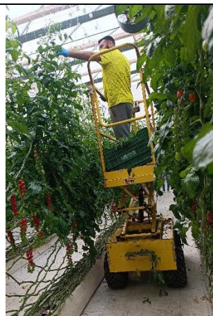
圖39、ATH-3000 專為溫室作物管理設計的電動液壓升降台車，搭載強力電動馬達、寬胎設計，具備液壓轉向與升降系統、防滑鋁製平台、自動充電器及便捷維護功能，能在各種地形上順暢作業
