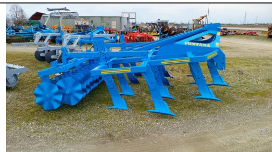
圖66、Fontana 展示之整地與深層鬆土機具，依據不同深度與土壤質地需求而設
