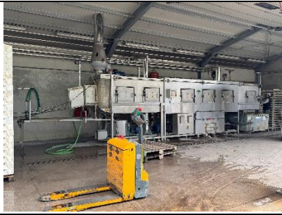
圖60、苗盤衛生管理為 Gremizzi 育苗體系一大特色，每次使用後須送至自動化清洗消毒機台進行高壓水洗、高溫殺菌與乾燥處理，並由品管人員隨機抽查以確保無病菌殘留
