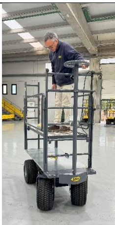
圖38、A4R-2000 專為溫網室作物管理設計的堅固型電動台車，具備寬輪穩定設計、腳踏式操控、前後行駛切換、可調速與電量監控功能，並附自動充電器，平台高度與寬度可依需求調整，便於高效作業與靈活搬運
