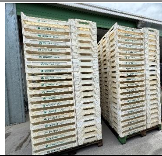
圖61、Gremizzi 採用可重複使用的硬式塑膠端盤，使用年限可達25年以上
