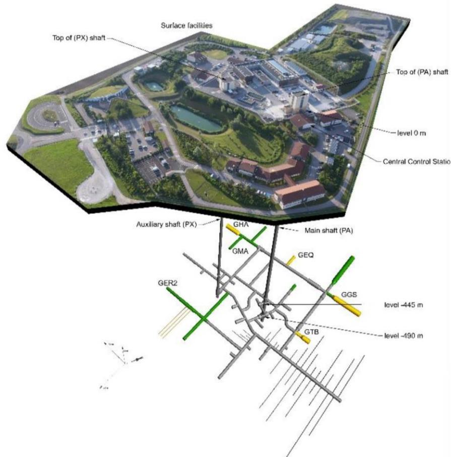
圖8、法國Meuse/Haute-Marne地下研究實驗室地表及地下設施示意圖
