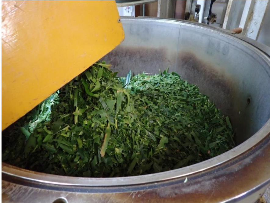
圖 17. 葉子切碎後裝入蒸餾鍋中進行蒸氣蒸餾，一次可以蒸餾 160 kg 的鮮葉
