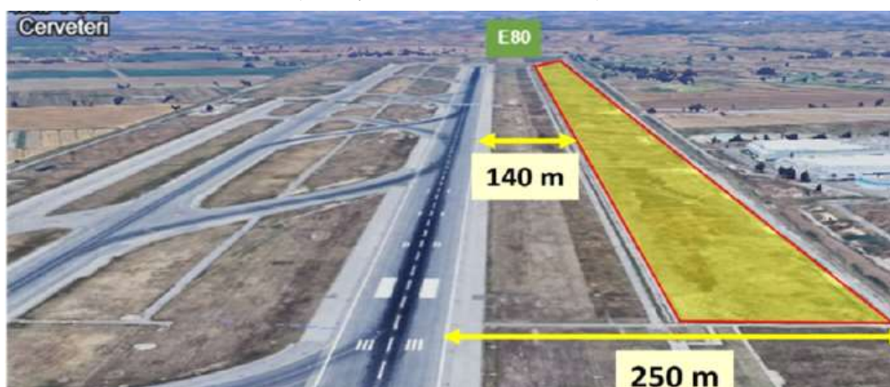
圖 6.5 太陽能系統離跑道距離示意圖
