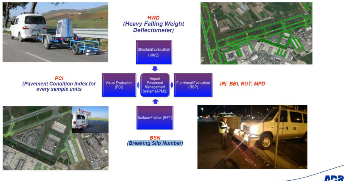
圖 3.24 羅馬機場鋪面管理系統 APMS 管理指標分類
