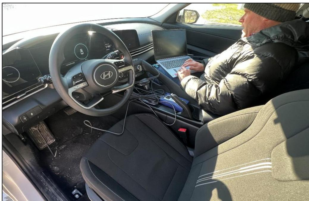
圖2.5-14 現代汽車 EDR 報告下載狀況
