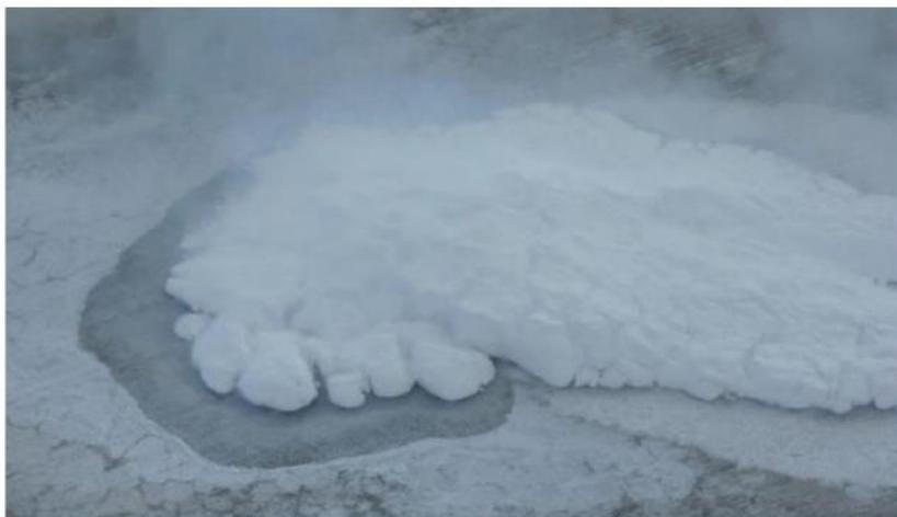
圖 8.液態氫洩漏後空氣中的氧氣及氮氣因低溫而固化
