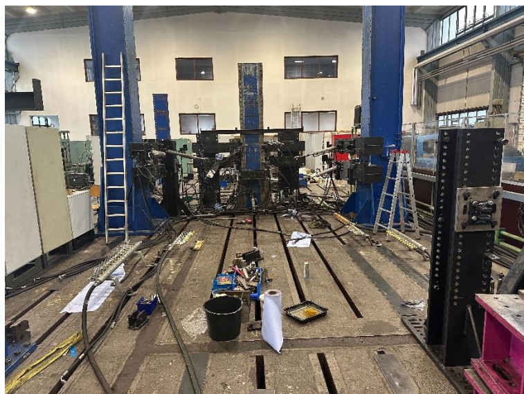
圖 8 轉向架框總成測試設備場地
