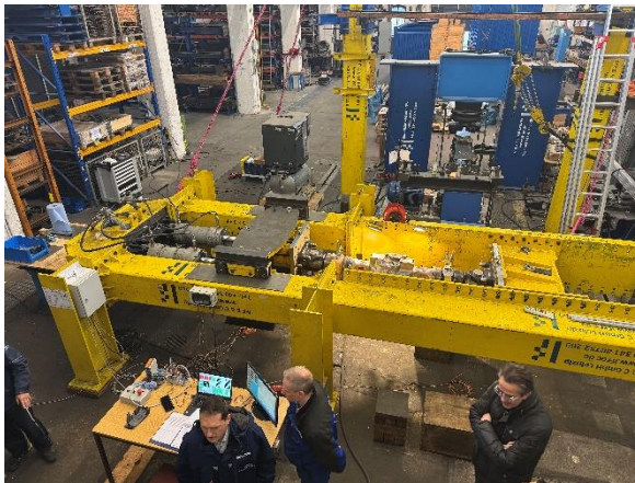
圖 5 連結器測試設備
