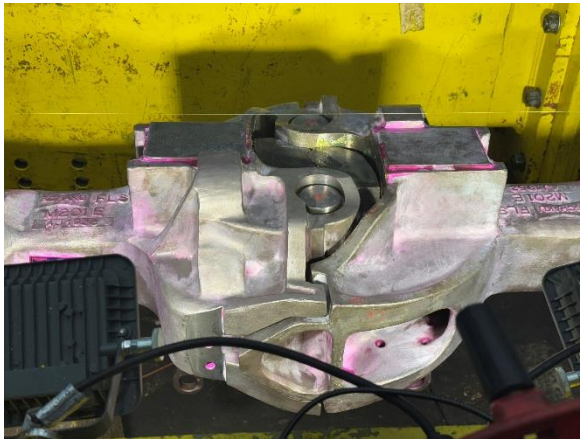
圖 3 連結器頭疲勞測試
