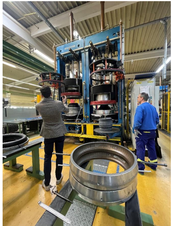
圖 28 橡膠氣囊壓制成形設備
