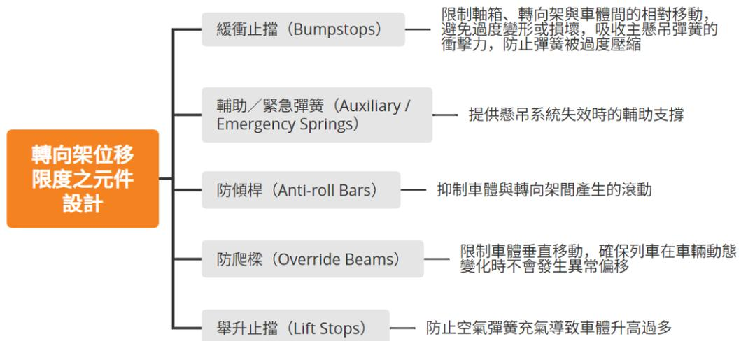
圖 3-37 轉向架位移限度之元件設計
