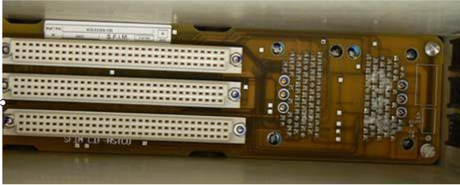
圖 3.10-2 第 5593 號機 HSTCU 主機板照片
