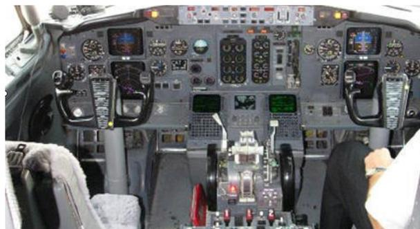
圖 3.1-1 具備第 3 代航空電子設備的駕駛艙
