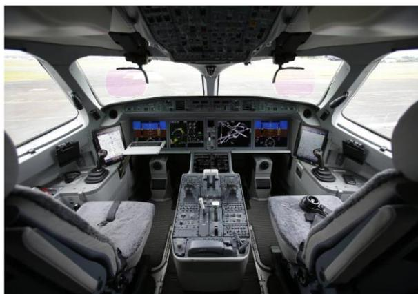
圖 3.1-2 具備第 4 代航空電子設備的駕駛艙
