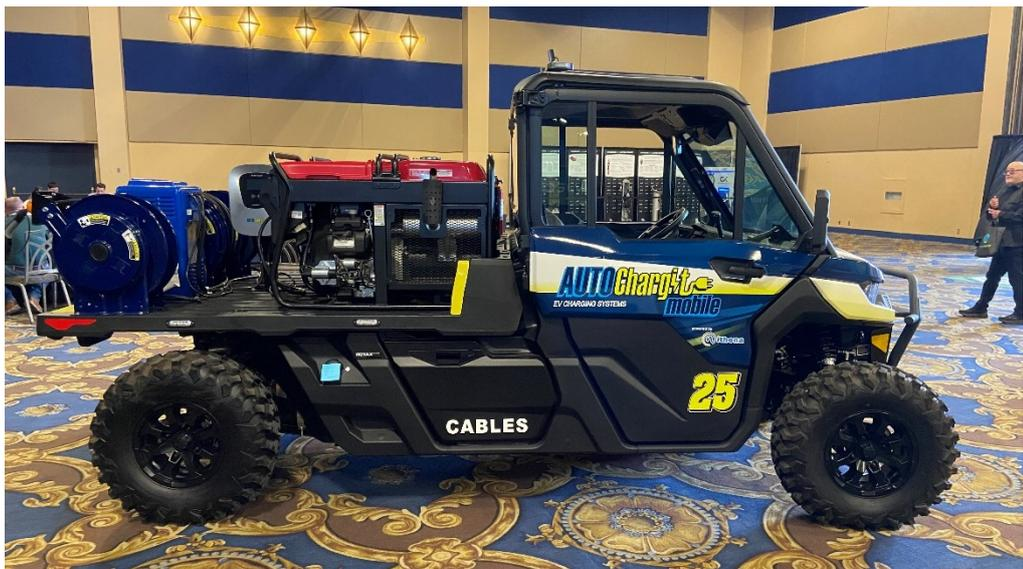
圖 21、AutoChargit Mobile UTV 全地形應用與緊急支援的能源機動車
