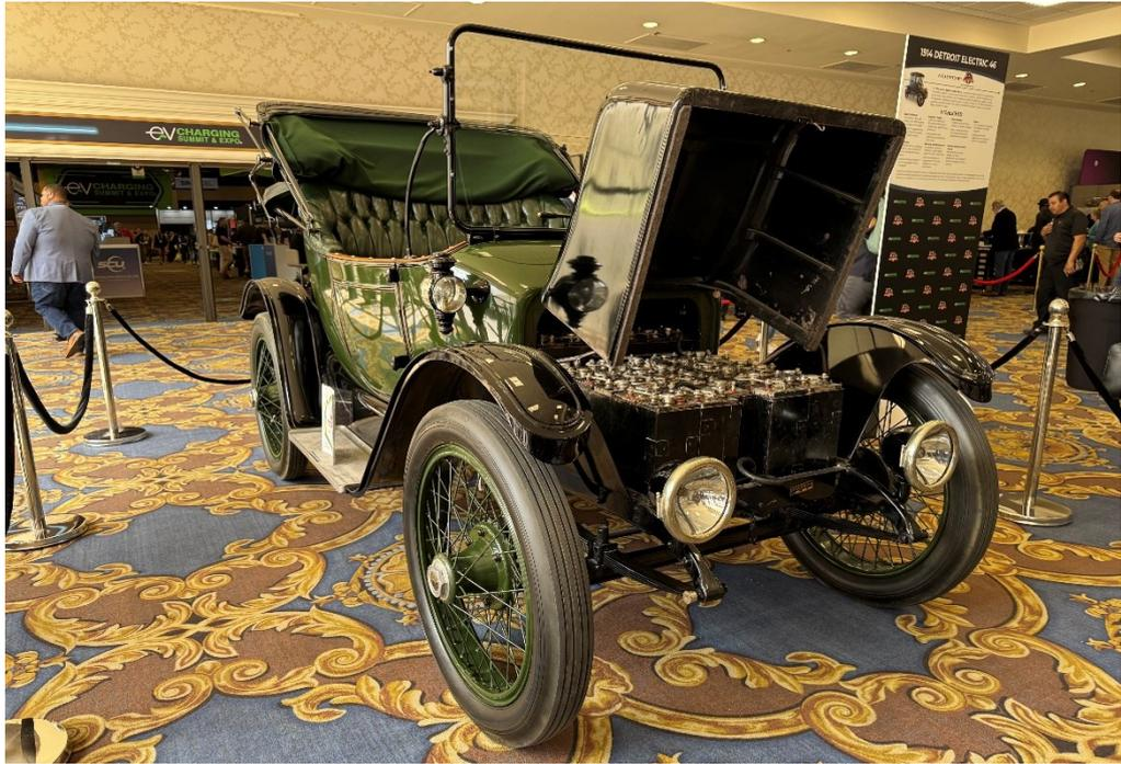
圖 23、1914 Detroit Electric Model 46 鉛酸電池電動車
