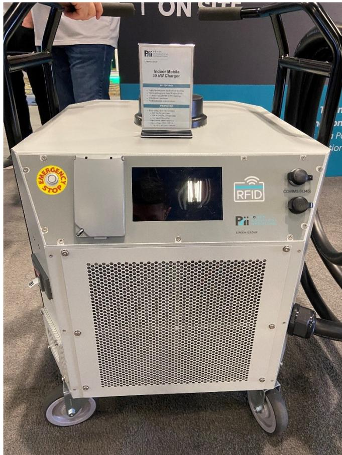
圖 18、Pii Indoor Mobile 30 kW 室內移動式充電設備
