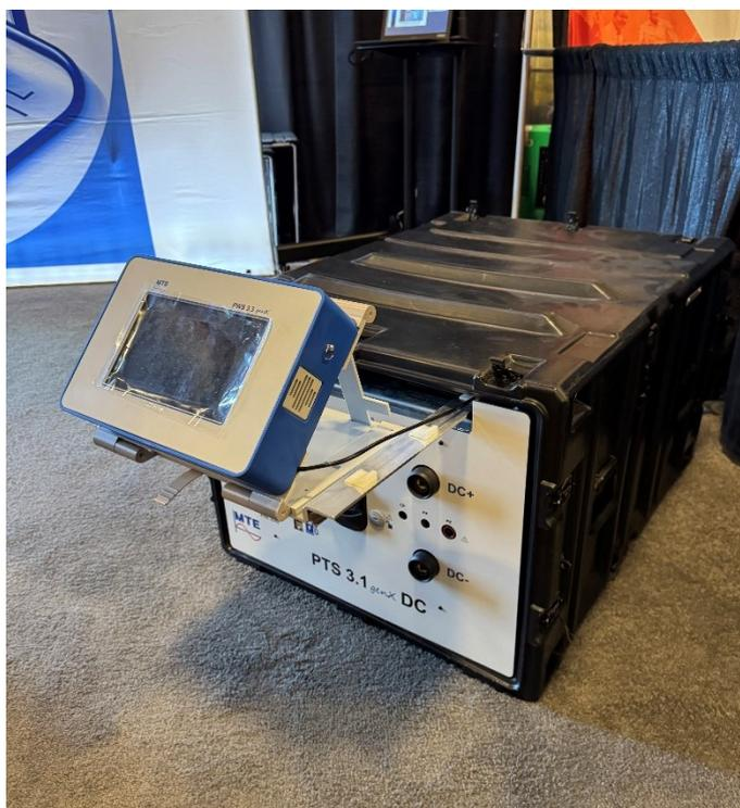
圖 22、MTE PTS 3.1 genX DC 直流充電系統可攜式測試設備
