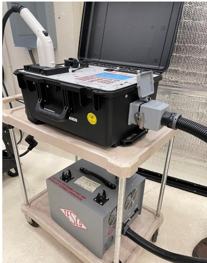
圖 7、加州 EVSE 檢測設備(TESCO T4000 Tester 及 PL4000 Programmable AC Load Box)
