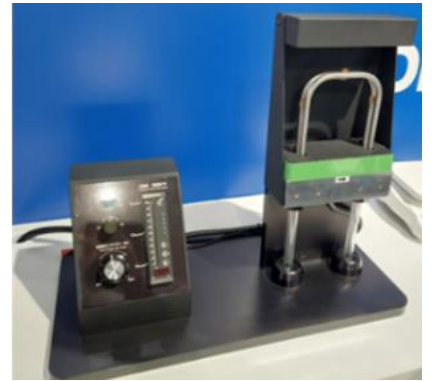
圖 3 分離型科氏力流量計外部及內部構造
