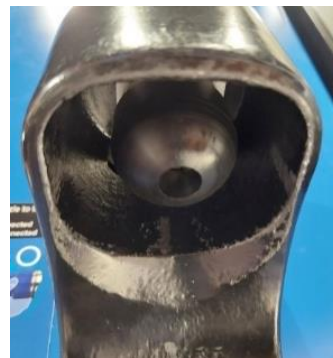
圖 4 加氫槍外觀、槍座噴氣孔與噴嘴圈口紅外線感應裝置
