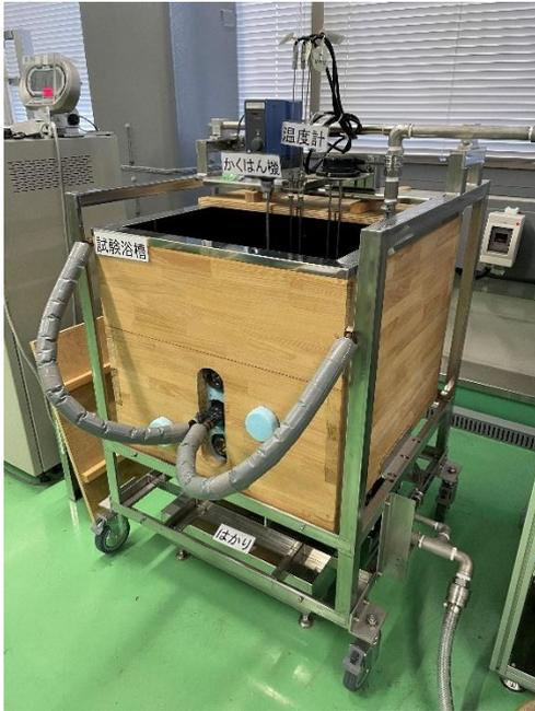
圖 15 試驗浴槽
