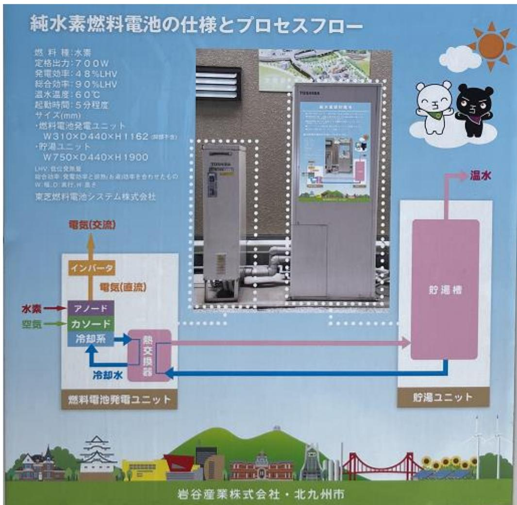
圖 26 住宅用純氫燃料電池熱電聯供系統運作示意圖
