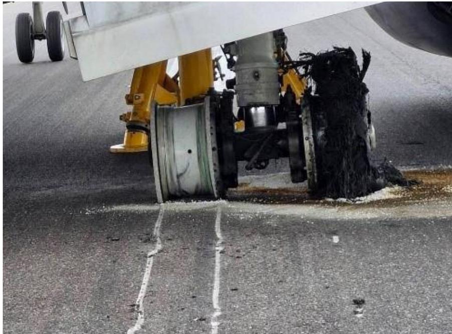
圖 3.6-1 波音 737MAX 輪胎在接觸跑道後發生爆裂
