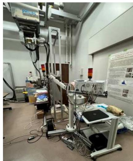
東京文化財研究所實驗室：X 光影像及 X 光螢光分析（XRF）設備
