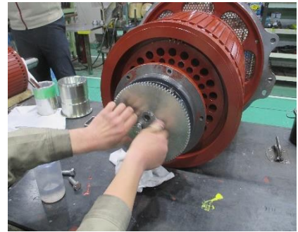
圖 4-6-2-6 安裝止擋片和螺絲
