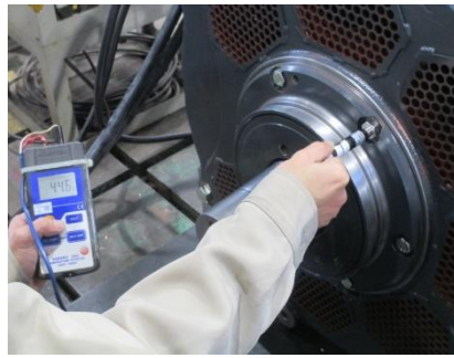
圖 4-6-3-8 測量 D 端軸溫
