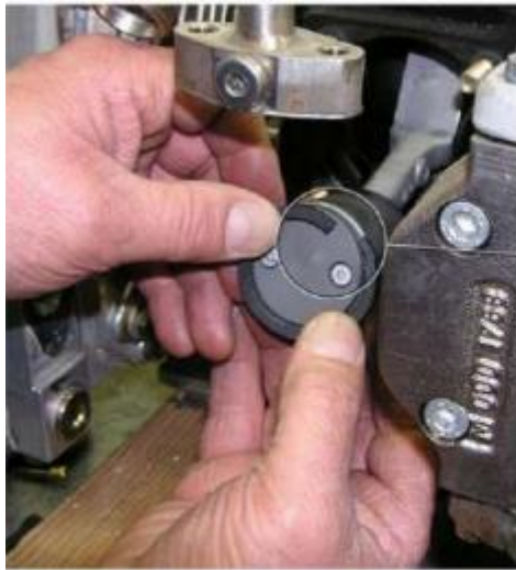
活塞環的封閉側，標有“T” 表示頂部。
