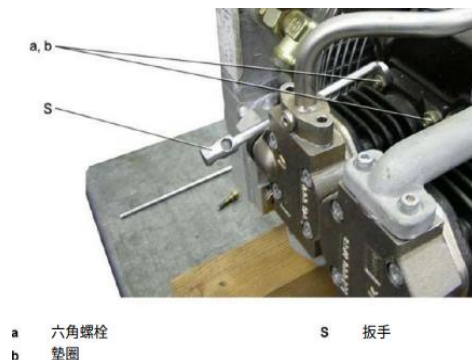
圖 4-8-3-2：鬆開高壓汽缸
