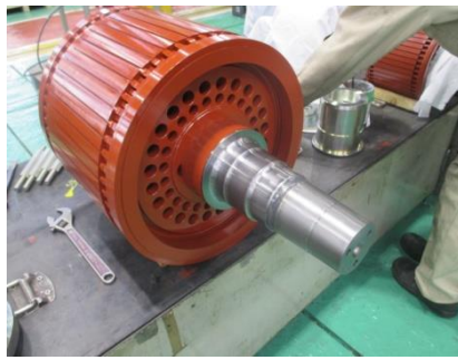
圖 4-6-1-26 清潔轉子軸面
