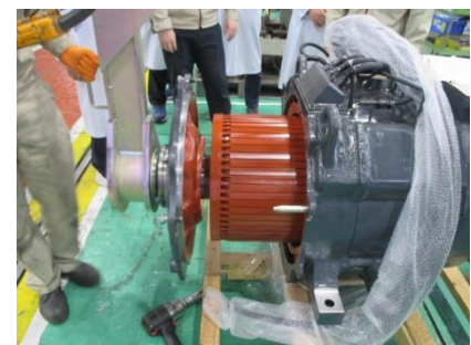
圖 4-6-1-12 將轉子水平移出
