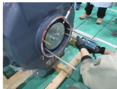
圖 4-6-1-11 氣動旋入螺栓
