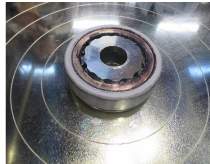
圖 4-6-1-29 D 端軸承分離(2)
