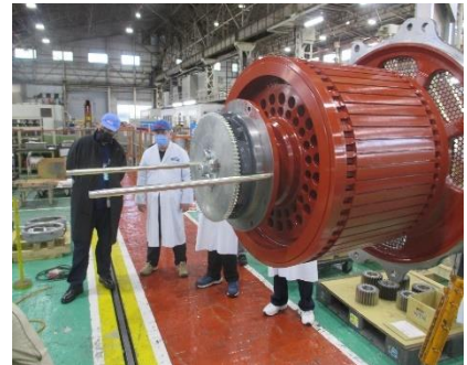
圖 4-6-2-9 安裝導引長螺栓
