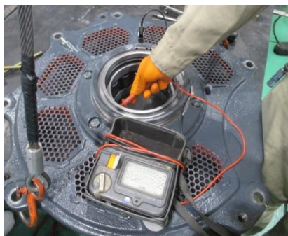
圖 4-6-2-2 高組計測量絕緣值
