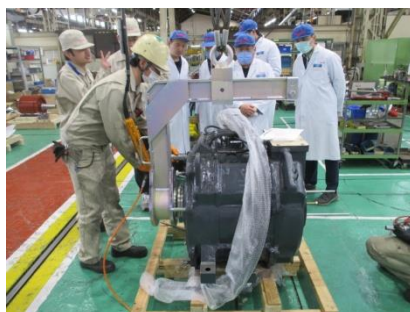
圖 4-6-1-10 確認安裝鬆緊度
