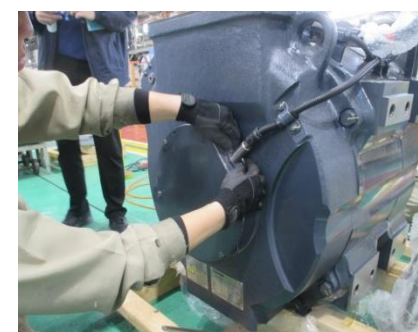
圖 4-6-1-3 速度探針拆解
