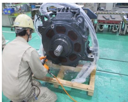
圖 4-6-1-1 D 端軸承室拆解
