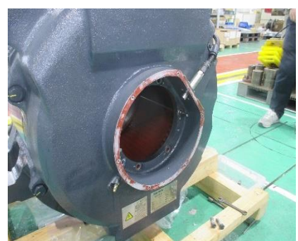
圖 4-6-2-12 注視導引長螺栓
