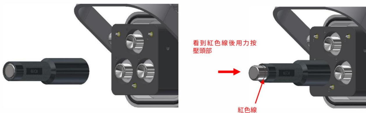
圖 4-3-2-3 YL14-6 型跨接電纜拆解接觸片(大)
