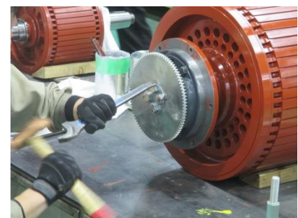
圖 4-6-1-15 拆除齒盤止擋片
