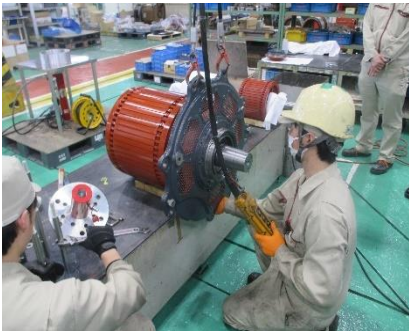
圖 4-6-2-7 使用吊具組裝轉子
