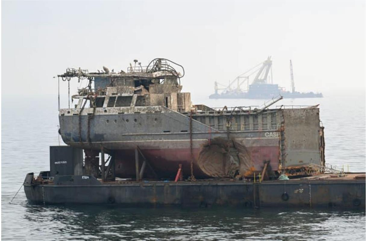
圖 3.1.15、切割後打撈之 MV Verity 後段殘骸（網路新聞照片）
