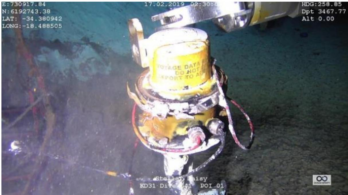
圖 3.1.7、打撈團隊於沉船殘骸回收 Stellar Daisy VDR 膠囊時之影像（網路新聞照片）
