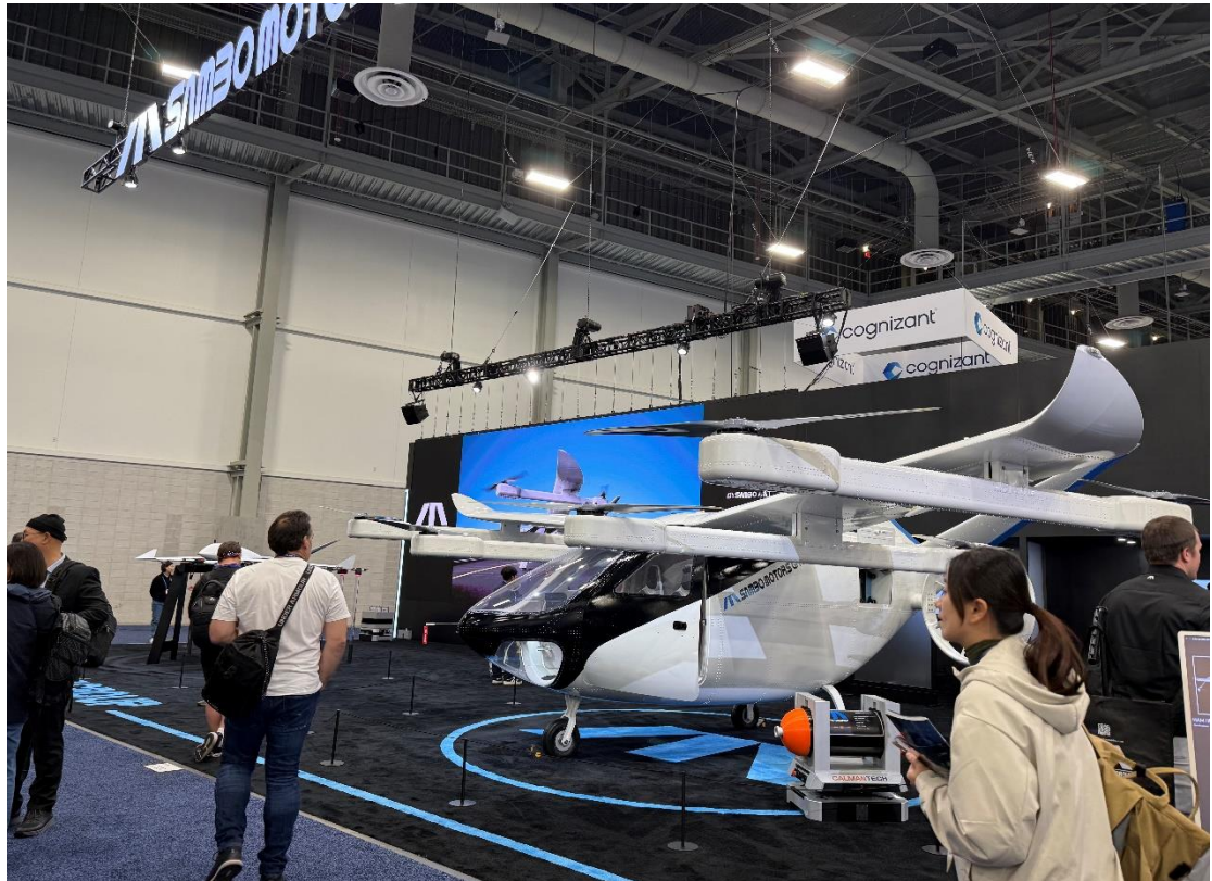
圖 32 Sambo Motors Group 氫燃料電池混合動力垂直起降 (eVTOL) 空中計程車_HAM III-2
