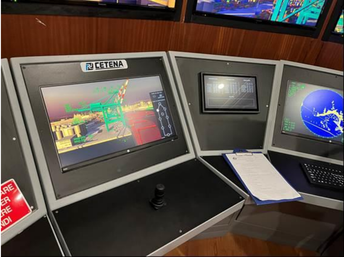
圖 20-操船模擬器現場-船側 CCTV 顯示情形
