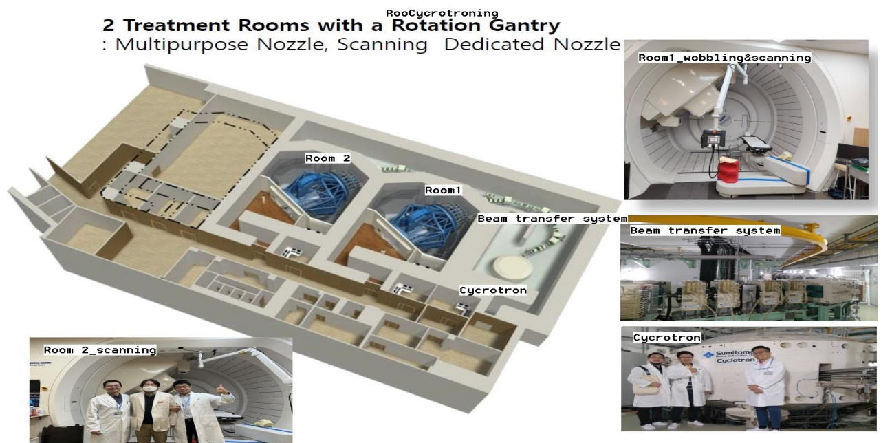
圖 2. 三星醫院質子治療設備空間，包含 Cyclotron、Beam transfer system、Room1、Room2
