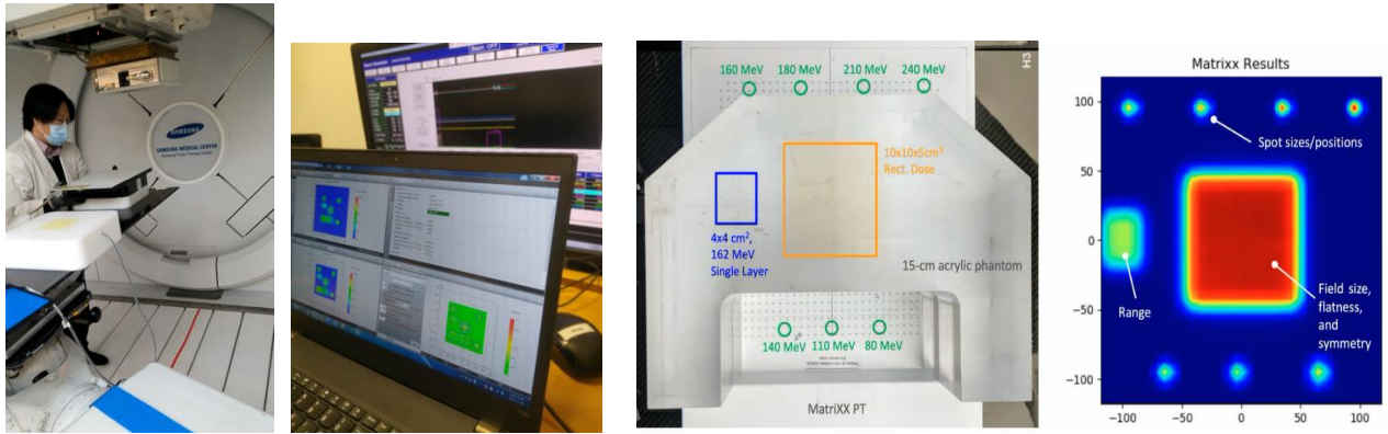
圖 12. 架設日品保用之量測假體、絕對劑量、射束位置比對-
