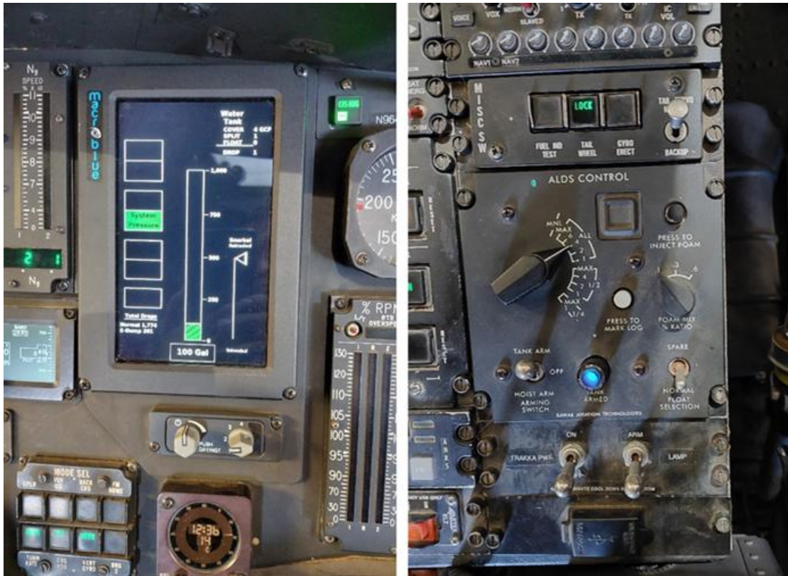
圖 15 首席飛行員介紹 HH-60L Firehawk 直升機滅火水箱系統
