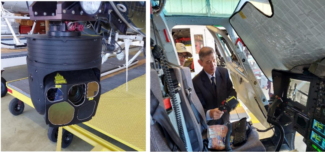
圖 19 操作前視紅外線 FLIR Star SAFIRE 380X 畫面
