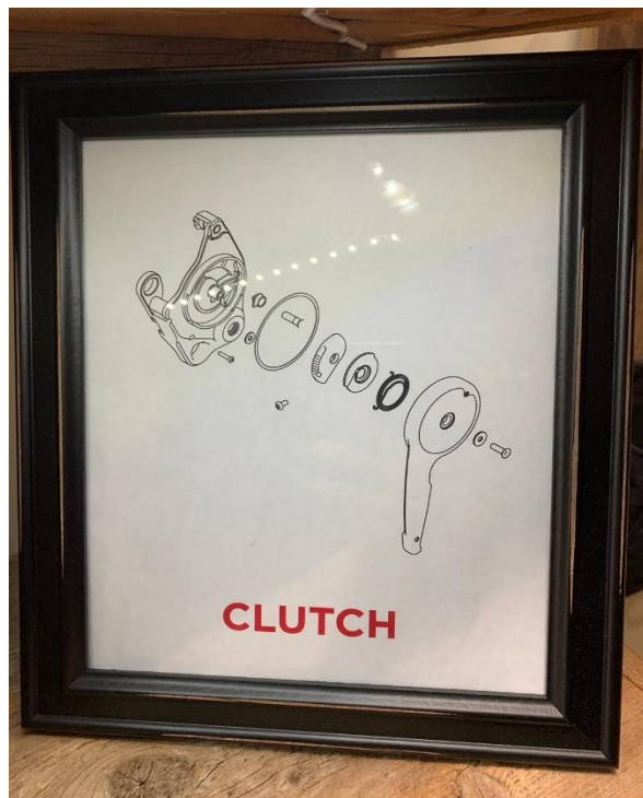
圖 29 CLUTCH 為現在先進國家繩索救援常使用的高效率拖拉器材
