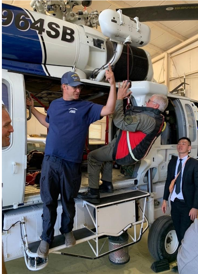
圖 17 Sikorsky HH-60L 救生吊掛+Bauman Bag 擔架救援裝備使用介紹
