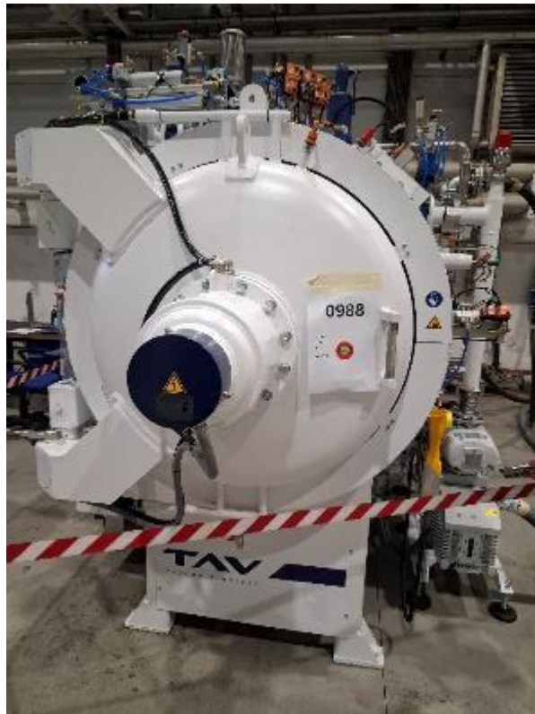
圖 5 熱處理爐組立完成全貌(編號 0988)
