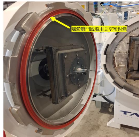
圖43 爐體艙門真空密封條
