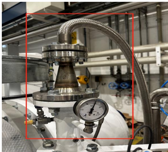
圖 18 氮氣( N_2 )冷卻管與錶壓
