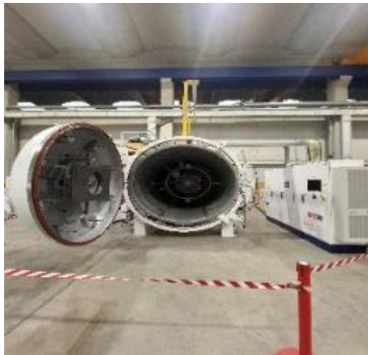
圖 3 組裝區域其他熱處理爐
