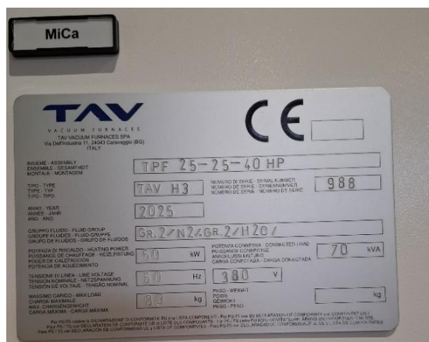
圖 6 熱處理爐機台銘牌標示
