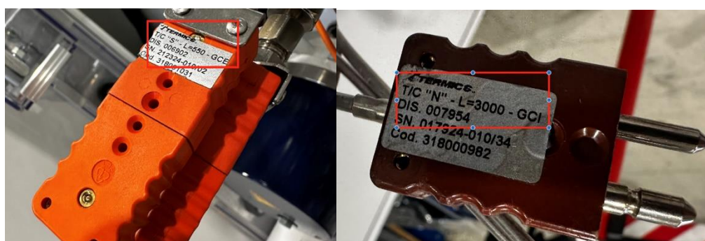
圖 14 S 型(左)與 N 型(右)熱電偶標示
