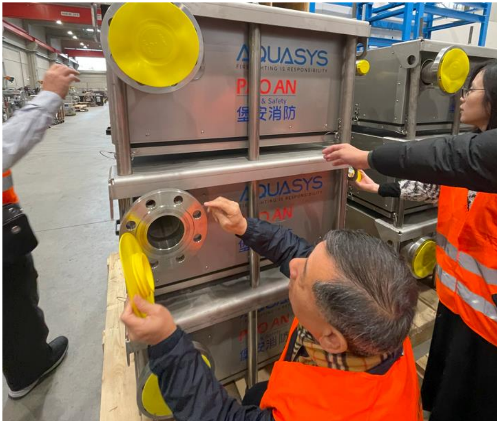
圖 39 細水霧設備分區閥規格檢視
