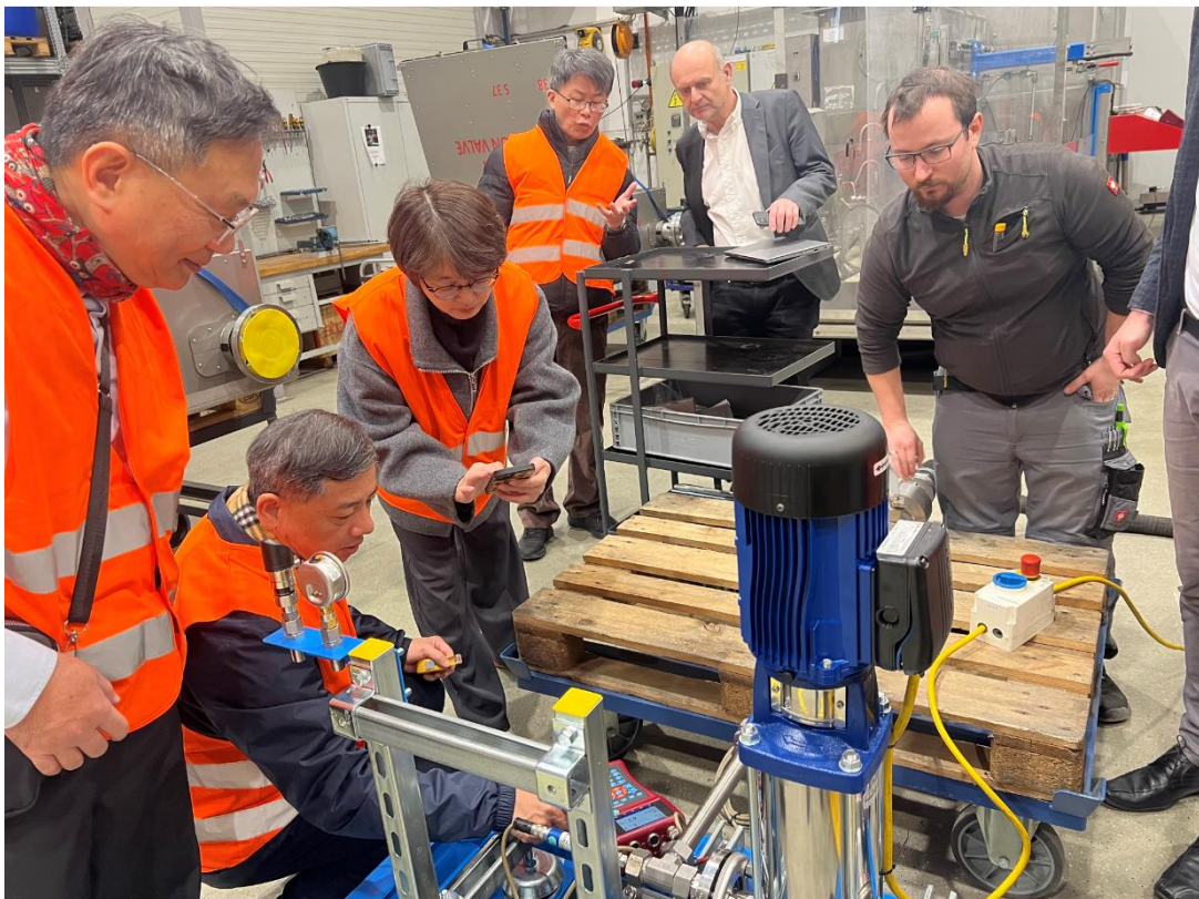
圖 35 廠驗檢視泵浦運轉狀況
