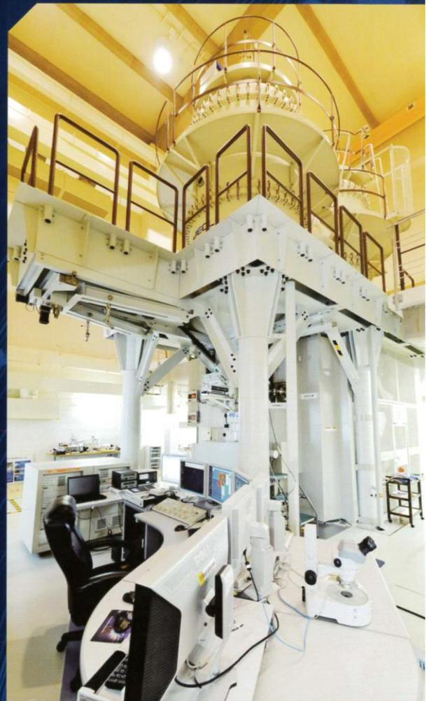
圖 10 超高壓電子顕微鏡簡介
