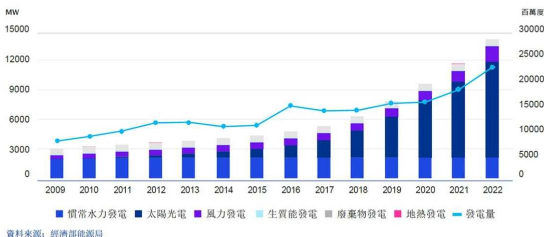
圖 7 臺灣再生能源設置現況與發電量統計圖
