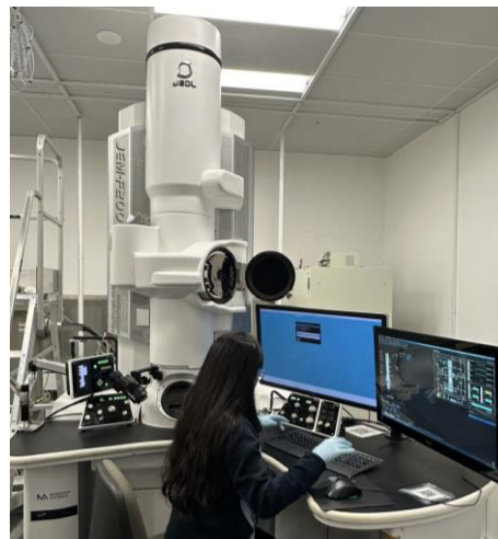
圖 80. 高解像能電子顯微鏡 F200 TEM 外觀及操作情形。
