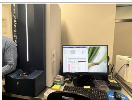
圖 31. 病蟲害診斷流程中，透過微生物鑑定質譜儀(MALDI)快速鑑定病害種類。
