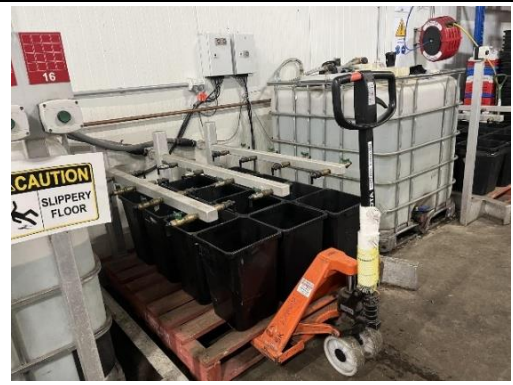
圖 4. 保鮮劑裝填區，進貨後的切花經過不良品汰除，整理放置於自動裝填保鮮劑的水桶，一次裝填 12 個水桶。
