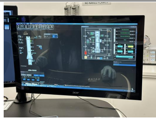
圖 84. 顯微鏡之電腦控制介面提供包含儀器參數設定及樣品位置調整等資訊，方便操作人員快速掌握即時狀態。
