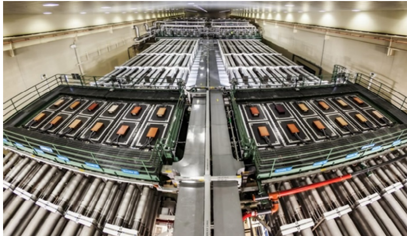
圖 8、國家點火設施雷射光系統之雷射間 (Laser Bay)
