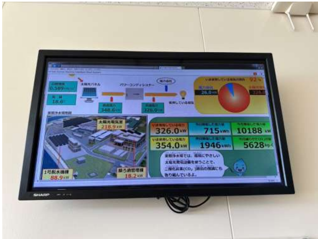
圖 38、參訪當日東陽淨水廠用電 92% 來及廠內自設太陽能版
