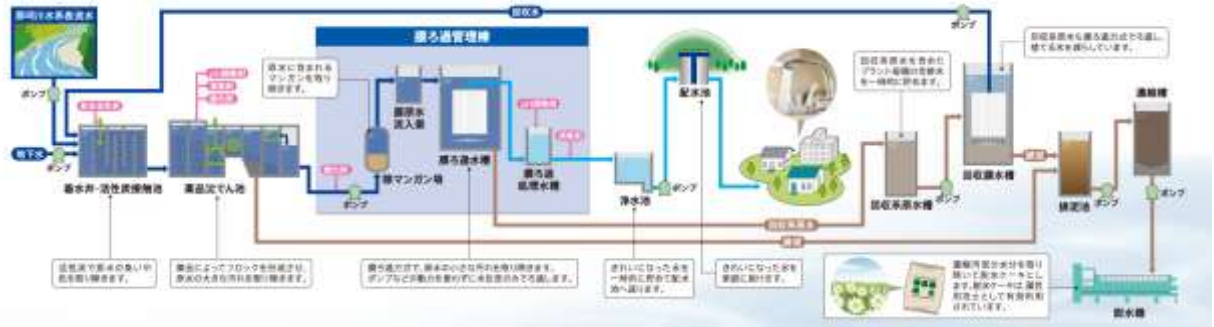
圖 34、東隈浄水廠處理流程(資料來源：春日那珂川水道企業提供)
