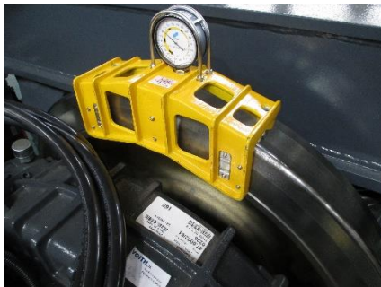
圖 3-28、車輪直徑量測
