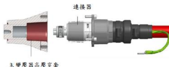
圖3-15、高壓穿套連結裝置
