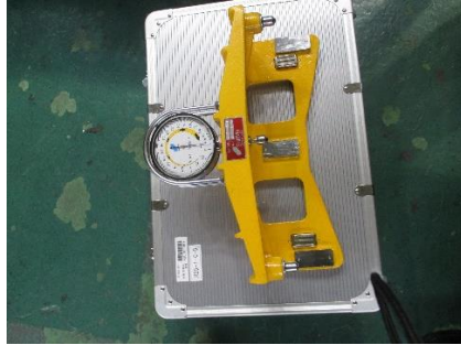
圖 3-26、車輪直徑量測工具
