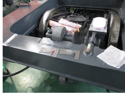
圖 3-27、車輪踏面確認量規
