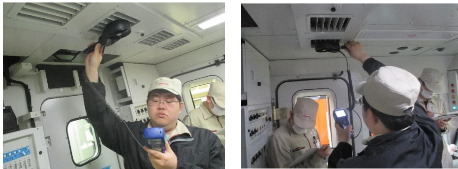
圖3-25、對量測點進行風量之量測
