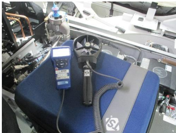
圖 3-23、扇葉式空氣流量計
