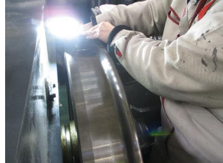
圖 3-29、使用厚薄規進行量測
