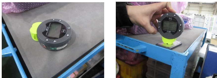
圖 3-1、膜厚計本體與校正
