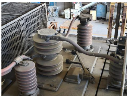
圖 5-3、E1000 型電力機車真空斷路器總成外觀
