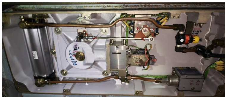
圖 5-13、電磁空氣式真空斷路器總成內部元件實體圖
