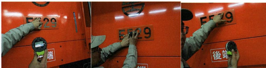
圖4-3、車號牌與車頭烤漆漆色有明顯落差之缺失改善
