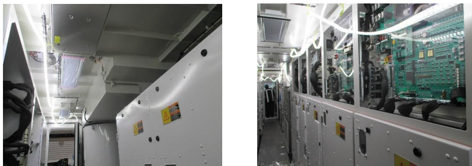
圖 6-1、車內走道使用 LED 燈條方便照明
