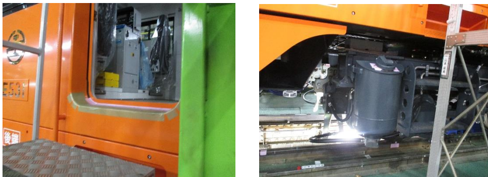
圖3-19、駕駛室與砂箱實施配重
