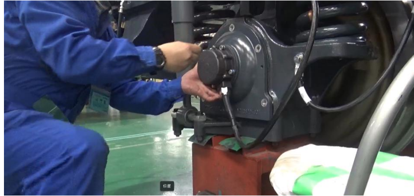
圖3-12、拆下車軸端蓋
