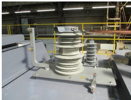
圖 5-5、E500 型電力機車電動型式真空斷路器總成外觀
