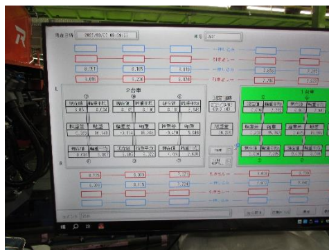
圖3-22、東芝人員對平均值過大之車軸進行調整
