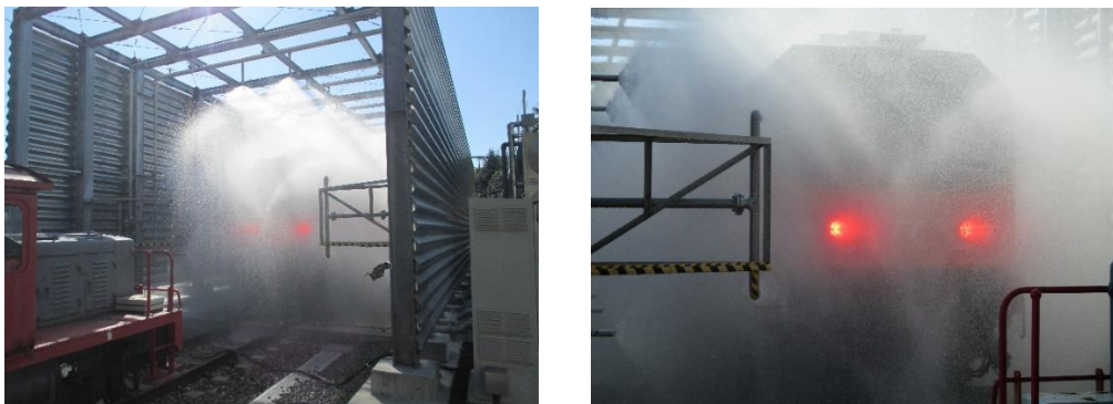
圖3-10、水密測試灑水狀況
