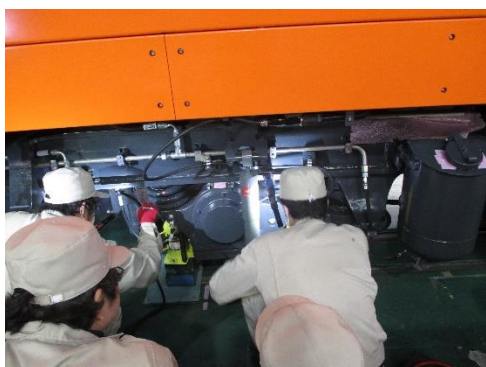
圖3-22、東芝人員對平均值過大之車軸進行調整
