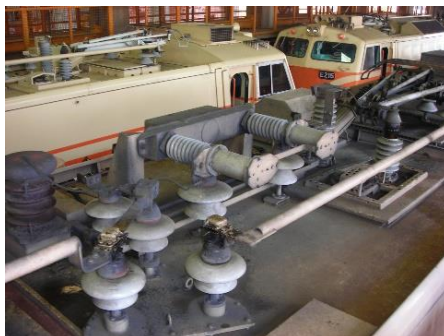
圖 5-2、GE 電力機車原廠所配置 PLB 型式真空斷路器總成外觀
