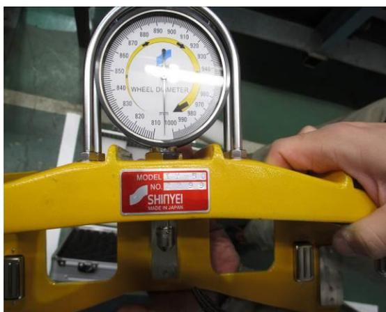
圖 3-6-6 輪徑測量工具 TY-50
