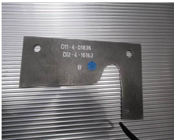
圖 3-6-8 車輪踏面確認量規
