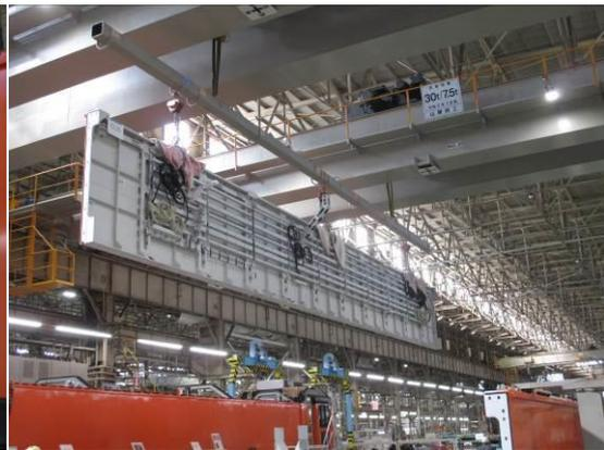
圖 3-1-6 B 工程 側牆結構吊掛組裝作業
