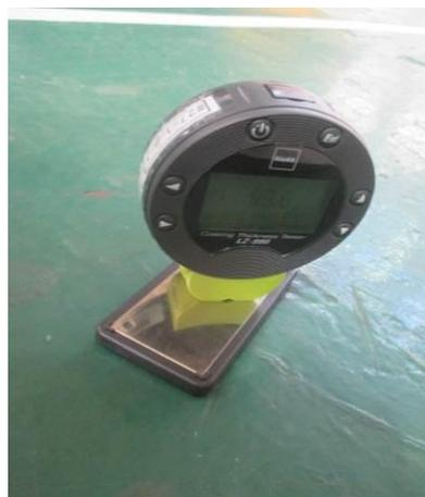
圖 3-2-3 配合校正塊確認精度
