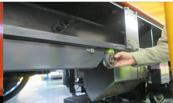
圖 3-2-8 車架膜厚量測
