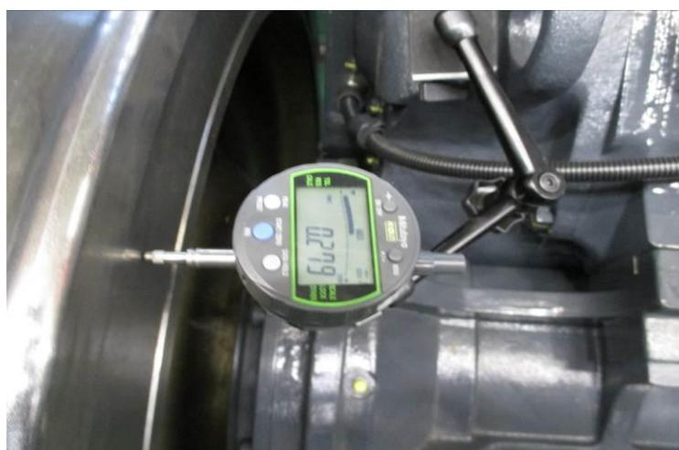
圖 3-6-5 指示量規顯示偏轉值
