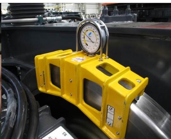
圖 3-6-7 車輪直徑量測
