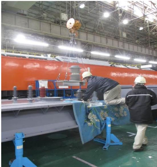
圖 3-1-9 D 工程 車頂 VCB 組裝作業
