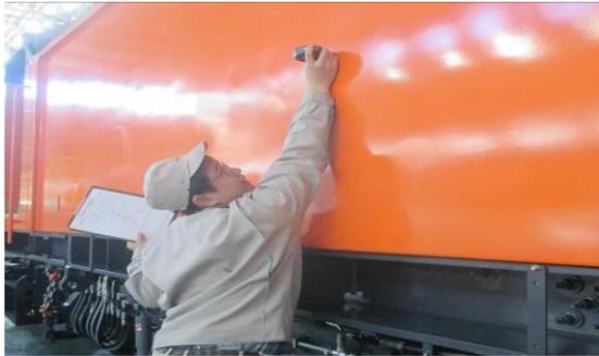
圖 3-2-5 機械室側牆膜厚量測
