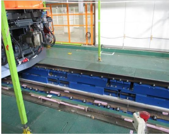
圖 3-4-2 軸重量測設備
