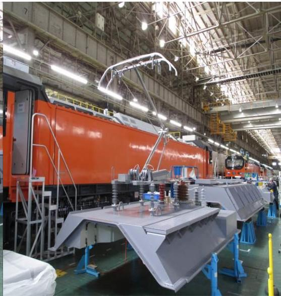
圖 3-1-10 D 工程 車頂集電弓組裝作業
