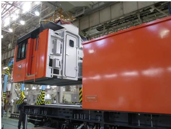
圖 3-1-5 B 工程 駕駛室吊掛組裝作業
