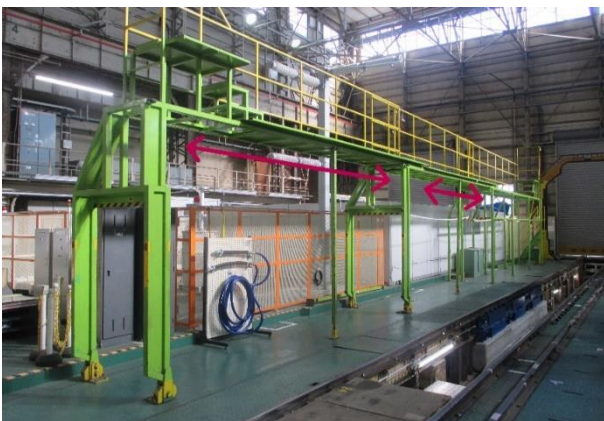
圖 5-21 高空作業平台可延伸部分
