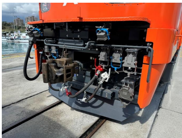
圖 6-2-8 E500 機車跨接電纜
